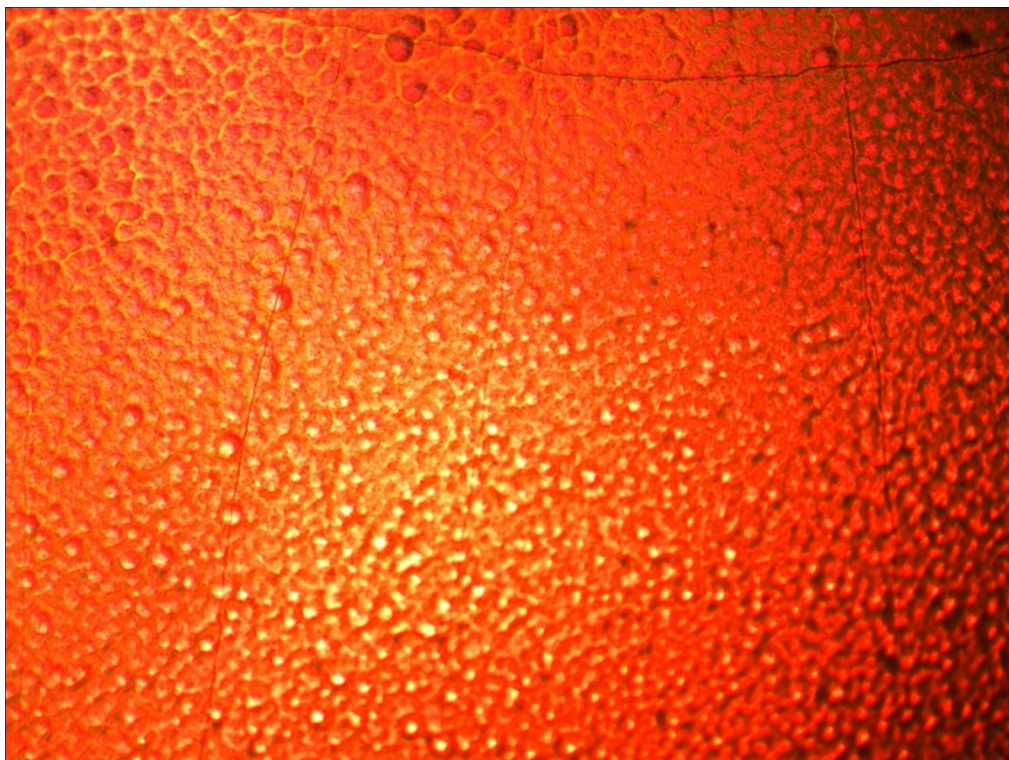
Рисунок 4.1. Микрофотография покрытия, полученного из стандартного электролита хромирования при i_k=60\text{A}/\text{дм}^2 и t=55^\circ\text{C} (увеличение в 400 раз).
