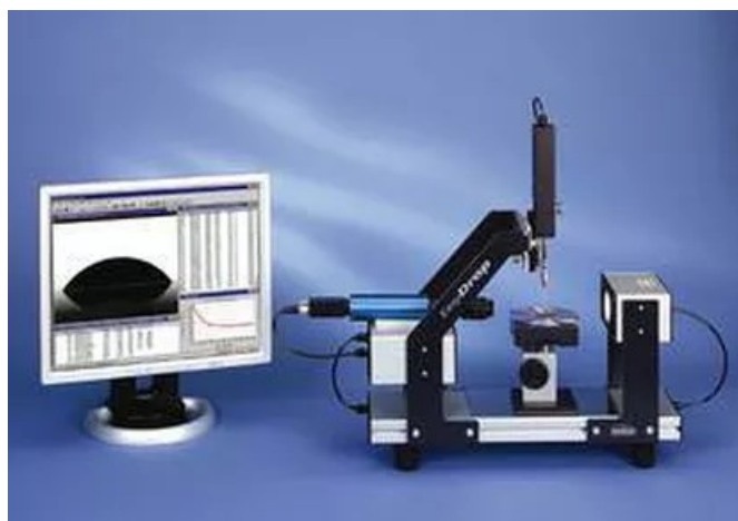
Рисунок 2.5. Фотография прибора для измерения угла смачивания Krupp DSA 20E [140].
