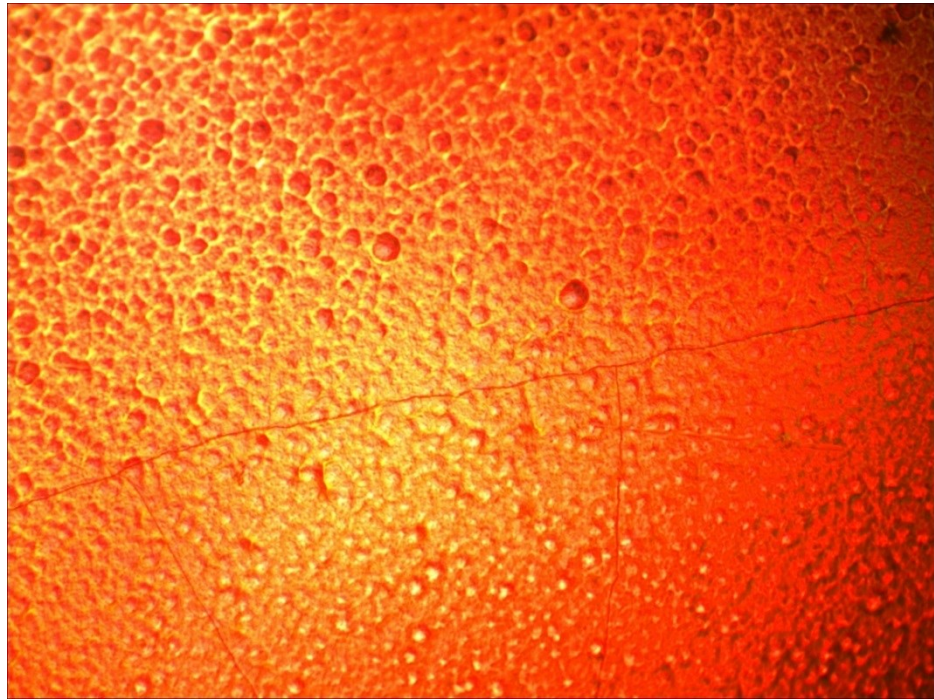
Рисунок 3.44. Микрофотография покрытия, полученного из стандартного электролита хромирования при i_k=60\text{А/дм}^2 и t=55^\circ\text{С} (увеличение в 400 раз).
