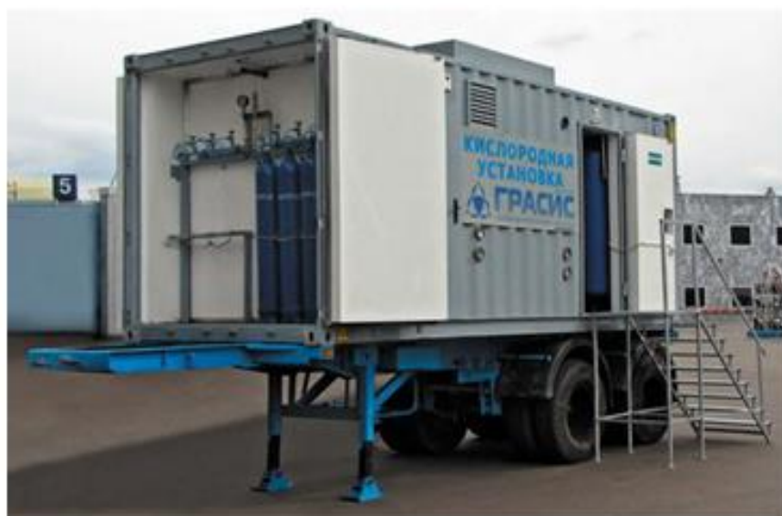
Рис. 1.14. Мобильная кислородная станция для производства кислорода
