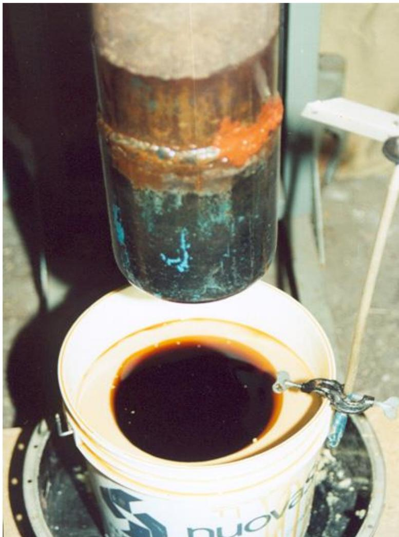
Рисунок 1.4 - Общий вид расплавленного СЖК в проплавленной трубой-кипятильником лунке
