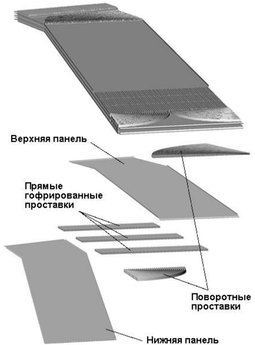
Рисунок 10.5.10 - Фрагмент сборки с основными элементами.
