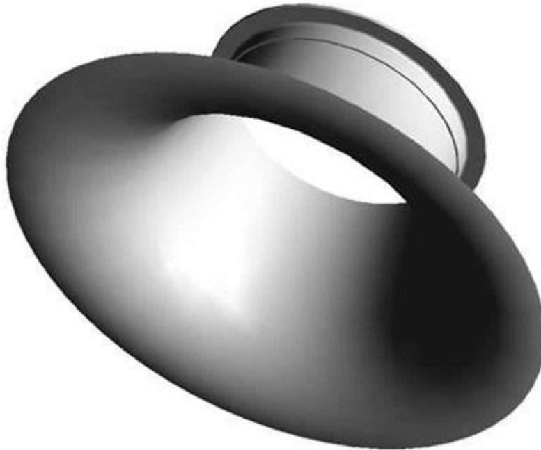
Рисунок 8.2.2 - Общий вид входного коллектора
