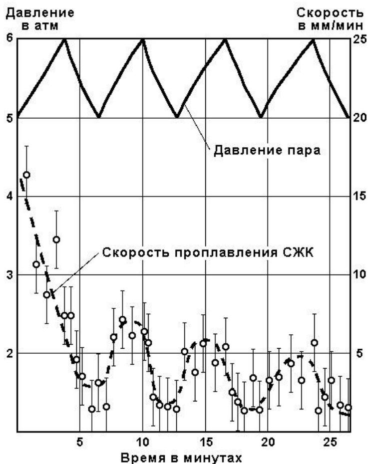
Рисунок 1.7 - Характерное изменение текущей скорости проплавления СЖК во времени при повышенной разнице температур
