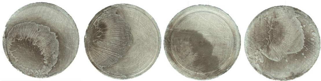
Рисунок 3.8 - Фотография отрыва покрытия, состоящего из сополимера АС и НЧ оксида железа
