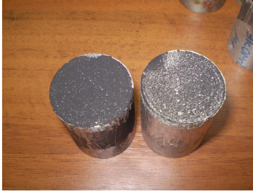
Рисунок 5 – Внешний вид бобышек после испытания на отрыв черного покрытия
