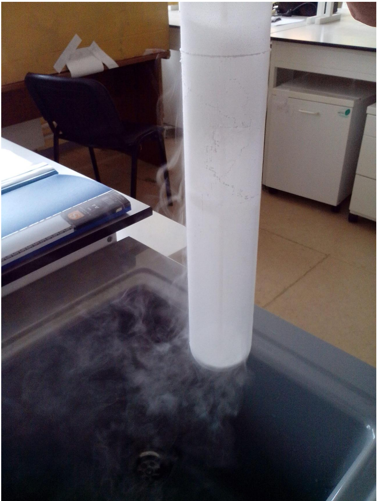
Рисунок 4.28 – Общий вид измерительной ячейки после эксперимента по десублимации диоксида углерода
