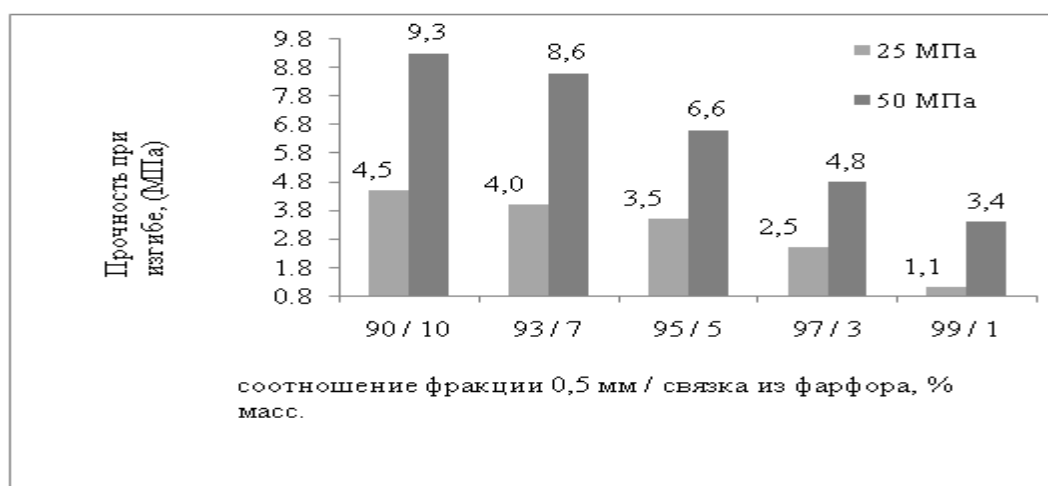
Рис. 3.3. Влияние соотношения фракции ЭПК 0,5 мм / связки из фарфора на механическую прочность образцов (обжиг при температуре 1350°C, 2 ч), полученных при давлениях прессования 25 и 50 МПа
