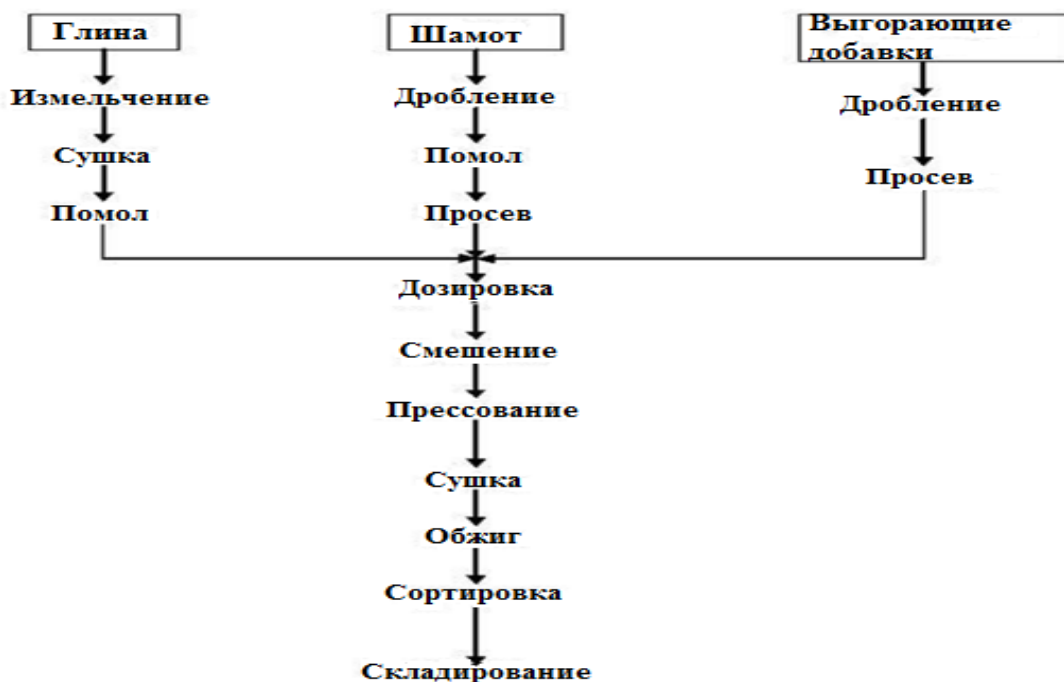
Рис. 1.1. Технологическая схема производства шамотных легковесов способом выгорающих добавок при полусухом прессовании [46]
