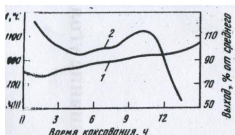
Рисунок 10 – Изменение в процессе коксования температуры газов (1) в подсводовом пространстве коксовых печей и их выхода (2)
