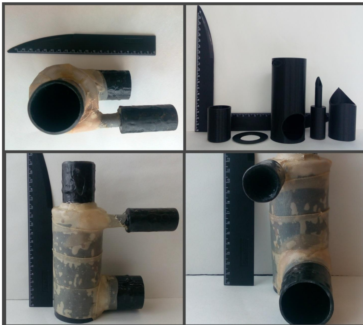
Рисунок 4.1.1 – Экспериментальная модель лабораторного эжектора
