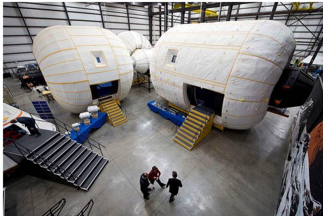
**Рисунок 1.1** – Модели TransHab на испытаниях
