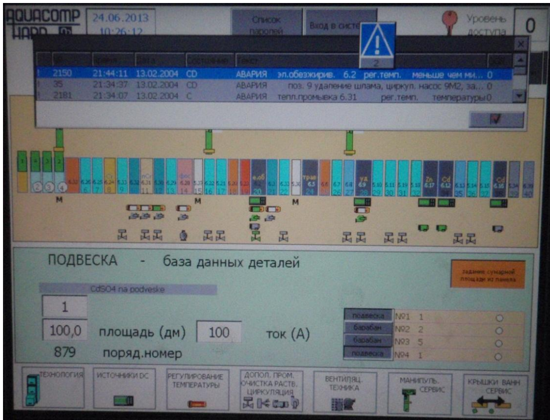
Рисунок 3.15. Панель управления автооператорной линией кадмирования.
