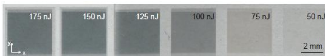
Рисунок 1.3.2.3 – Зависимость интенсивность “затемнения” от энергии импульса [14].
