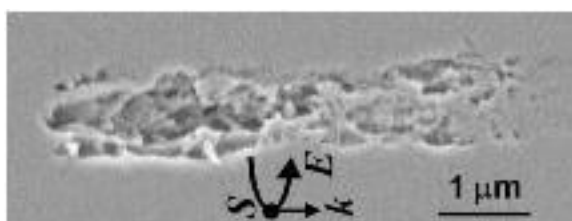
Рисунок 1.2.1.2 – Изображение, полученное с помощью СЭМ во вторичных электронах, структуры, записанной лазерным пучком круговой поляризацией [38].
