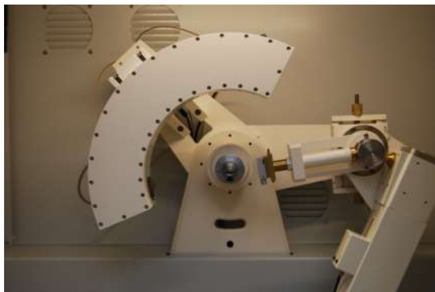
Рисунок 2.8. Внутреннее устройство дифрактометра Equinox 2000 (Inel Inc, France).
