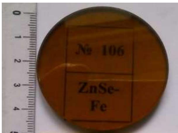
Рисунок 3.5. Активный элемент \text{ZnSe:Fe}^{2+} лазера.
