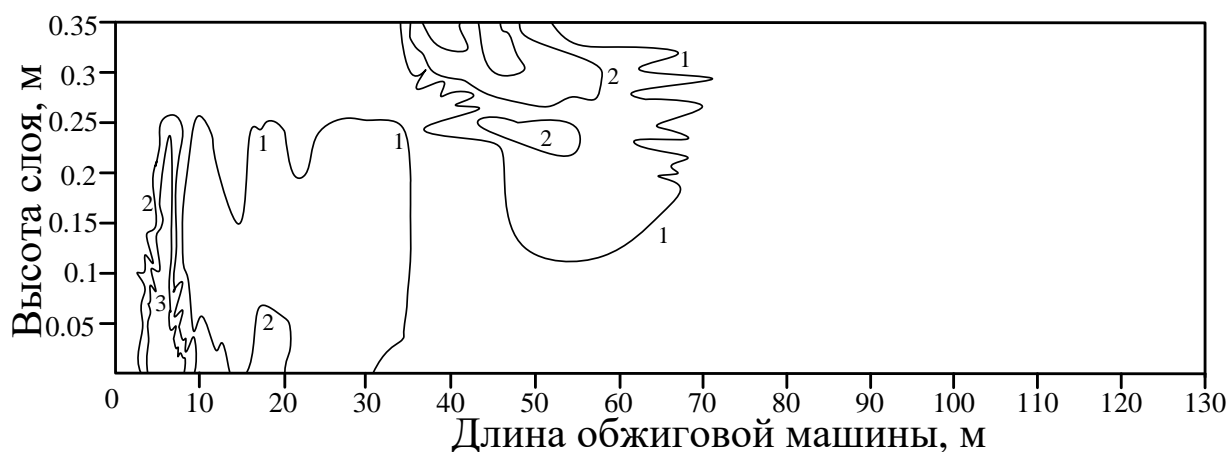
Рис. 2.4.2. Параметрическое семейство кривых, характеризующих интенсивность сушки материала окатышей в слое I , \text{кг}/(\text{м}^2 \cdot \text{с}) \cdot 10^3
