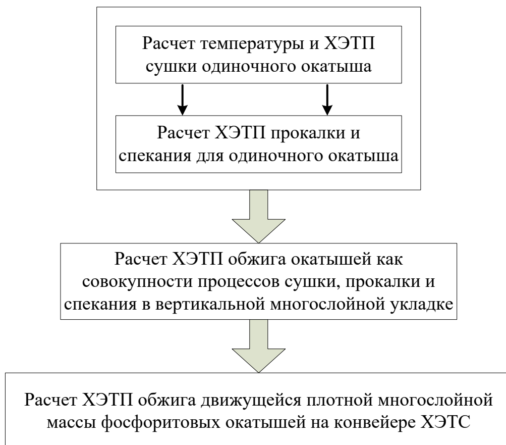
Рис. 7.1.2. Упрощенная схема формирования иерархии классов при объектно-ориентированном программировании многомасштабной математической модели
