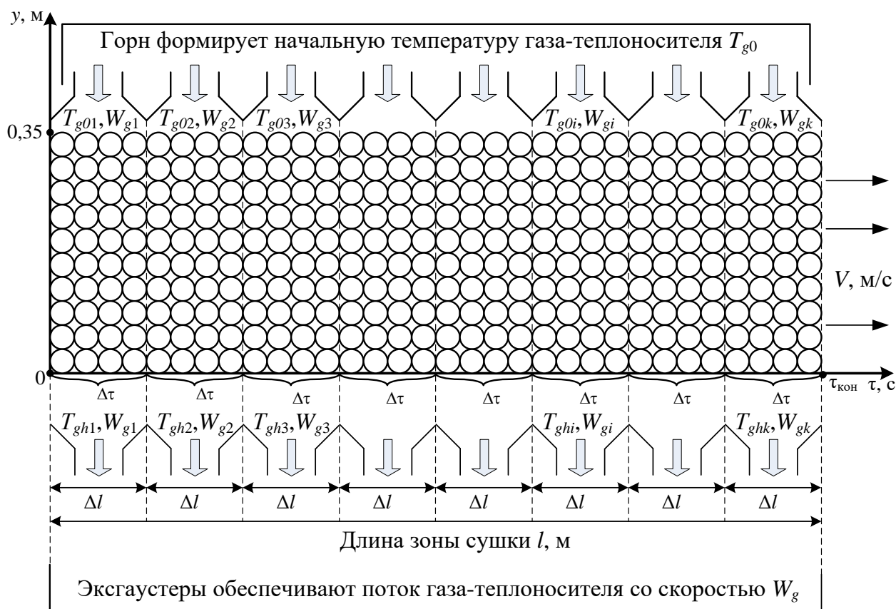
Рис. 4.1.1. Дискретизация времени пребывания окатышей в зоне сушки длиной l конвейерной обжиговой машины 0 \leq \tau \leq \tau_{\text{кон}} в зависимости от прохождения отдельных вакуум-камер длиной \Delta l , в которых формируется вектор управляющих переменных X_i(T_{g0i}, W_{gi})
