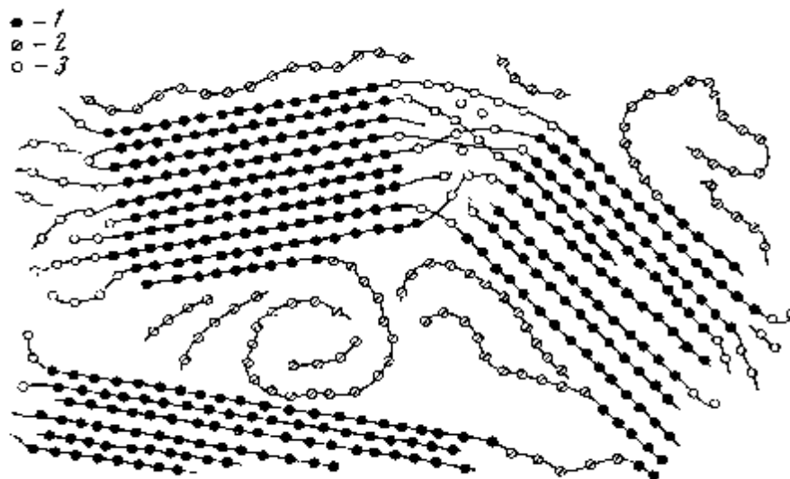
Рис. 1.9. Схематическая кристаллитная модель структуры углеродного материала [88]
