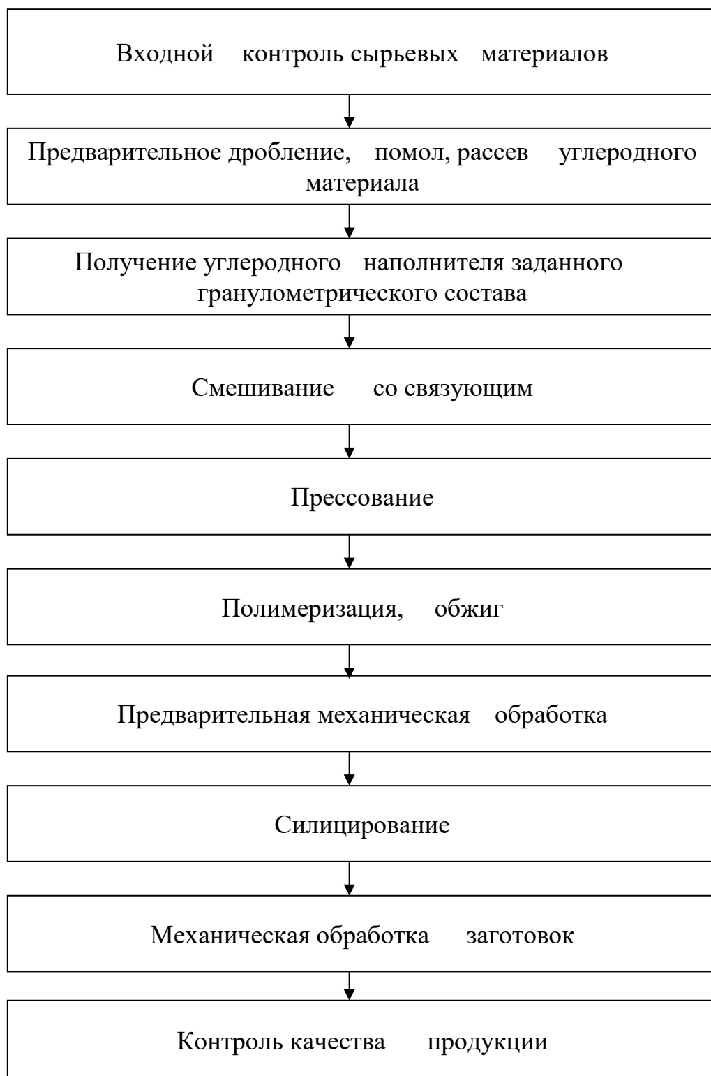
Рис. 1.1. Технологическая схема изготовления силицированного графита типа СГП
