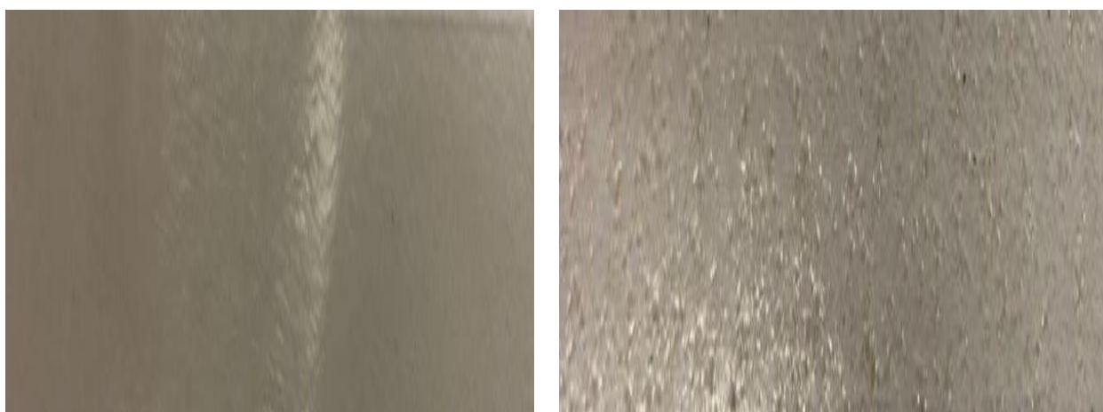
Рисунок 3.7 – Микрофотографии полимерных пленок на основе ПВХ с наполнителем бентонитом: а – фирмы Sigma Aldrich; б – природный, ООО «Домвин»
