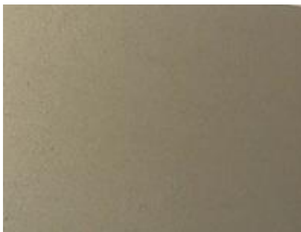
Рисунок 3.6 – Образец пленки, изготовленной на основе ПВХ с бентонитом, при температуре 170 °С
