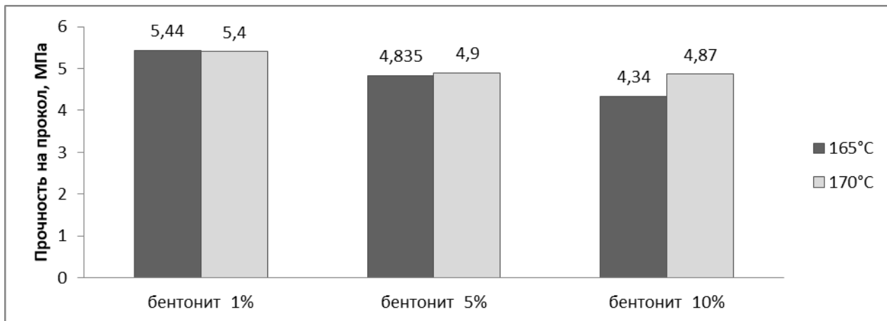
Рисунок 3.5 – Зависимость прочности полимерных ПВХ-наполненных бентонитом пленок при различной температуре формования: 1 – 165°С; 2 – 170°С
