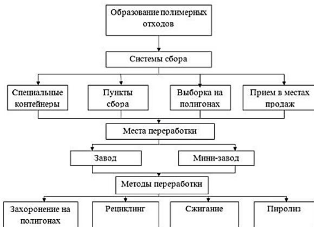
Рисунок 1.8 — Схема жизни полимерных отходов от образования до утилизации
