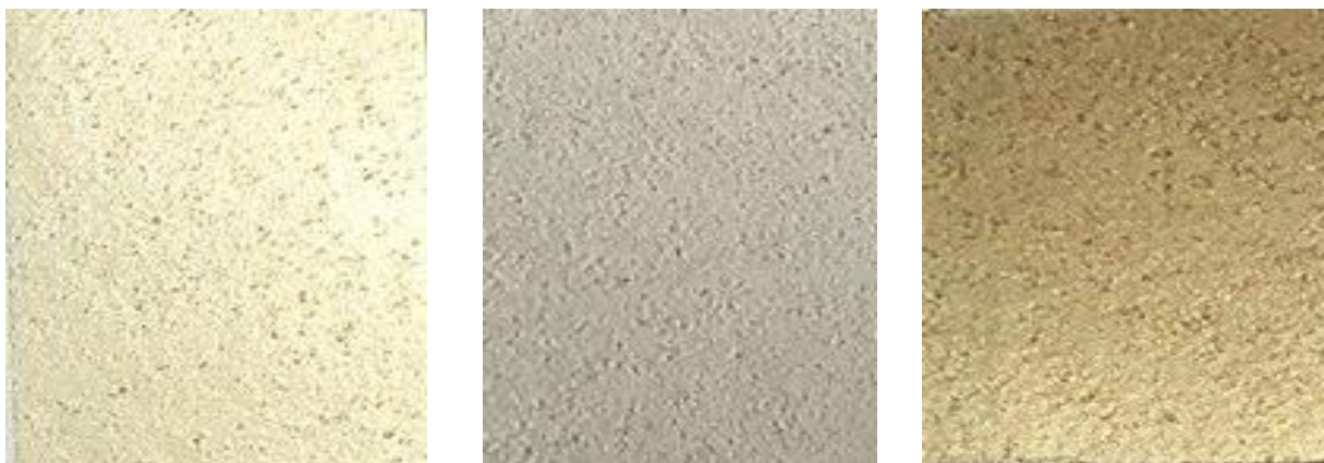
Рисунок 3.9 – Готовые образцы пленок, изготовленных на основе ПВХ и пектина с массовой концентрацией 5% при различном времени вальцевания, мин: а) 2; б) 5; в) 10
