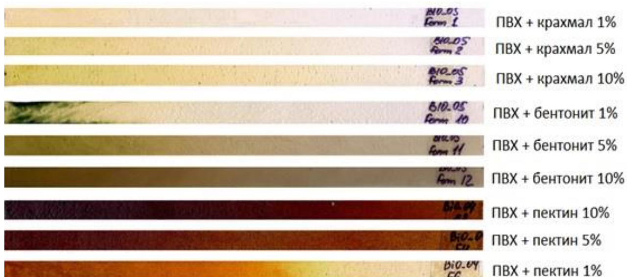
Рисунок 3.29 – Образцы полимерных композиций после теста на термическую стабильность
