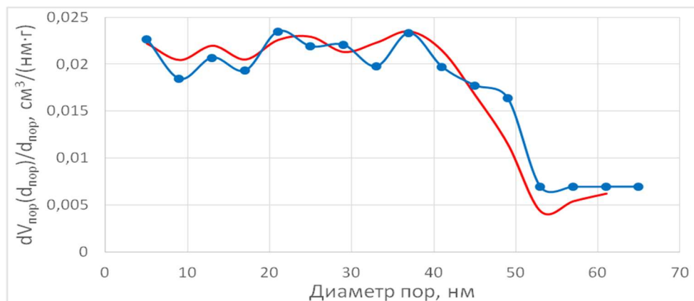
Рисунок 3.20 – Дифференциальная кривая распределения пор по размерам для образца 3
