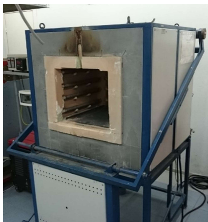
Рисунок 2.4 – Внешний вид электропечи сопротивления косвенного нагрева
