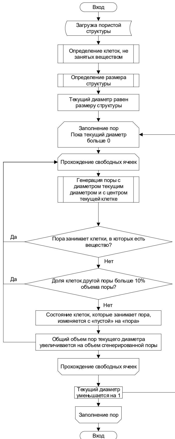
Рисунок 3.4 – Блок-схема алгоритма расчета распределения пор по размерам
