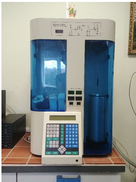
Рисунок 2.6 – Объемнометрическая установка Nova 1200e
