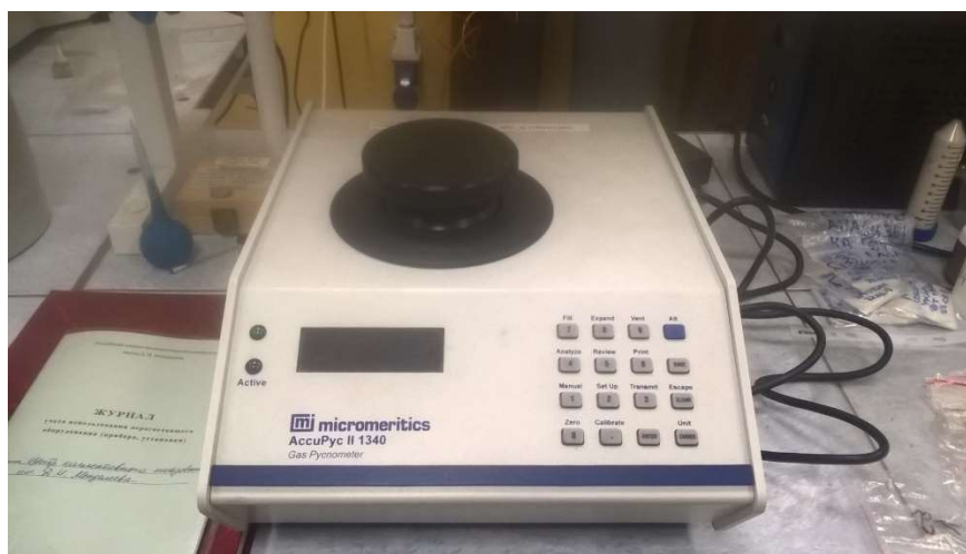
Рисунок 2.18 – Автоматический гелиевый пикнометр "AccuPyc II 1340" (Micromeritics)
