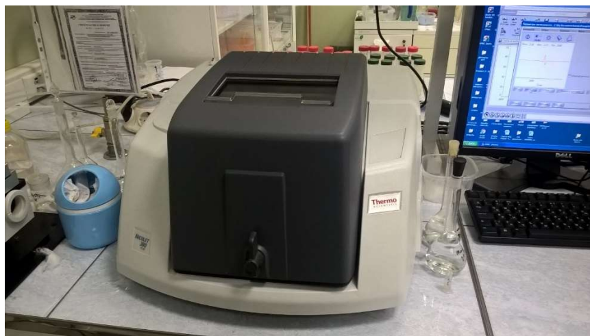
Рисунок 2.13 – ИК-Фурье спектрометр Nicolet380
