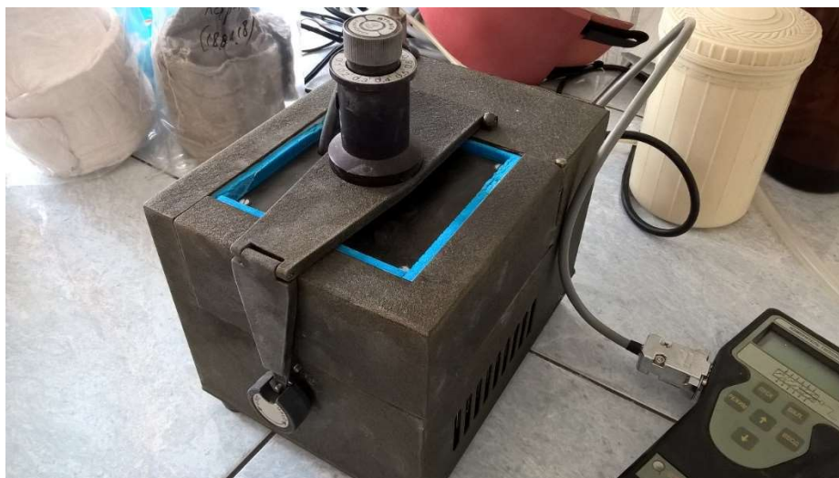
Рисунок 2.20 - Измеритель теплопроводности ИТП МГ4 "100"
