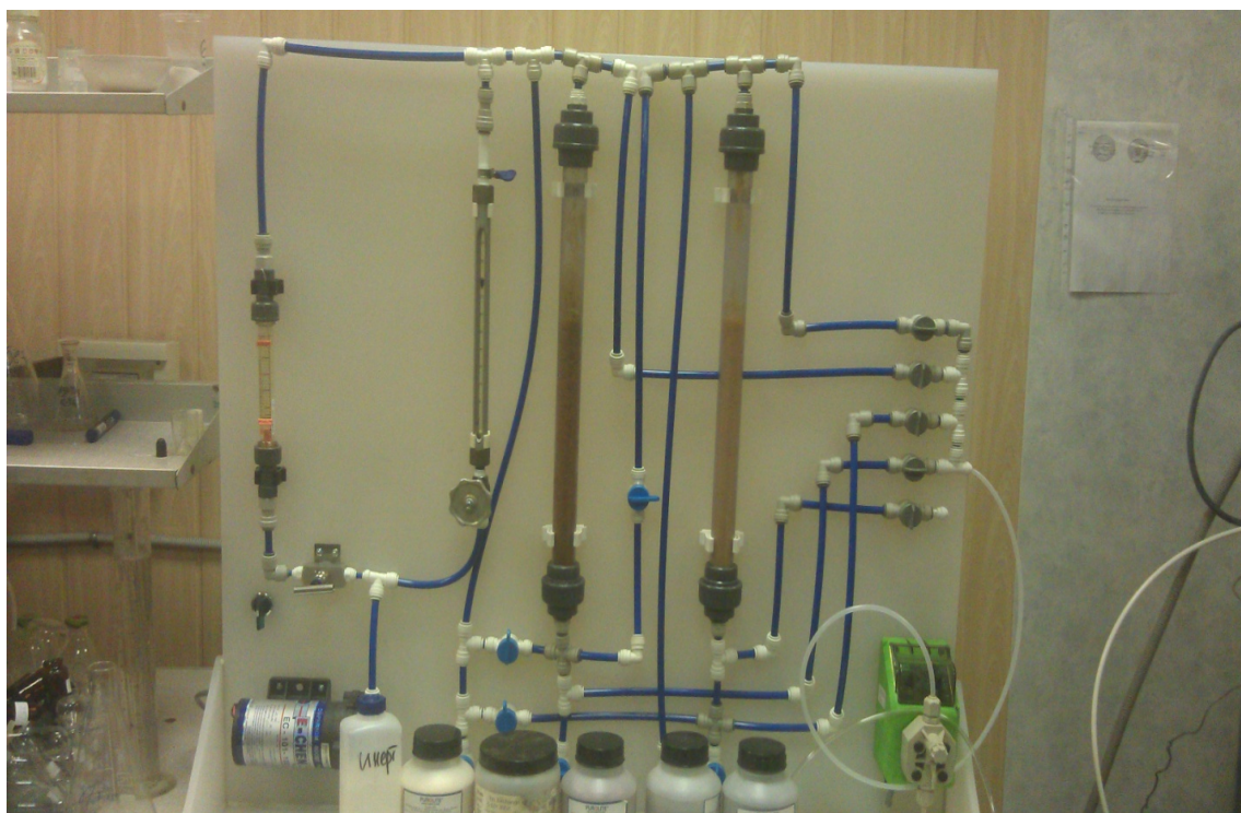
Рис.19. Внешний вид установки ионного обмена
