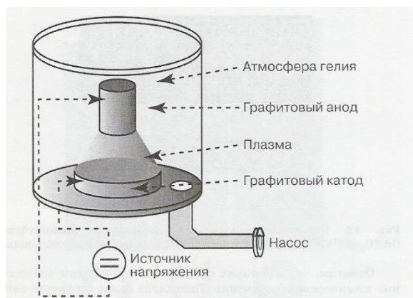
Рисунок 1.5 - Камера для электродугового метода получения УНТ в атмосфере He.
