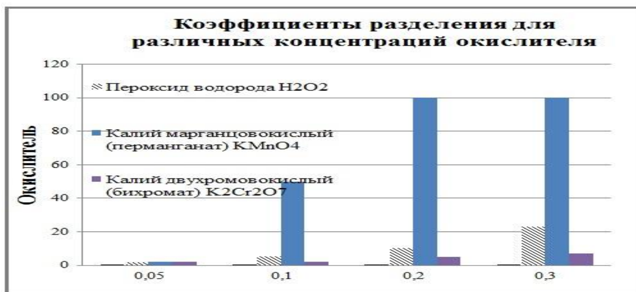
Рис. 2.5 Влияние различных окислителей на коэффициент распределения микропримеси As (III) между жидкостью и паром HF азеотропного состава
