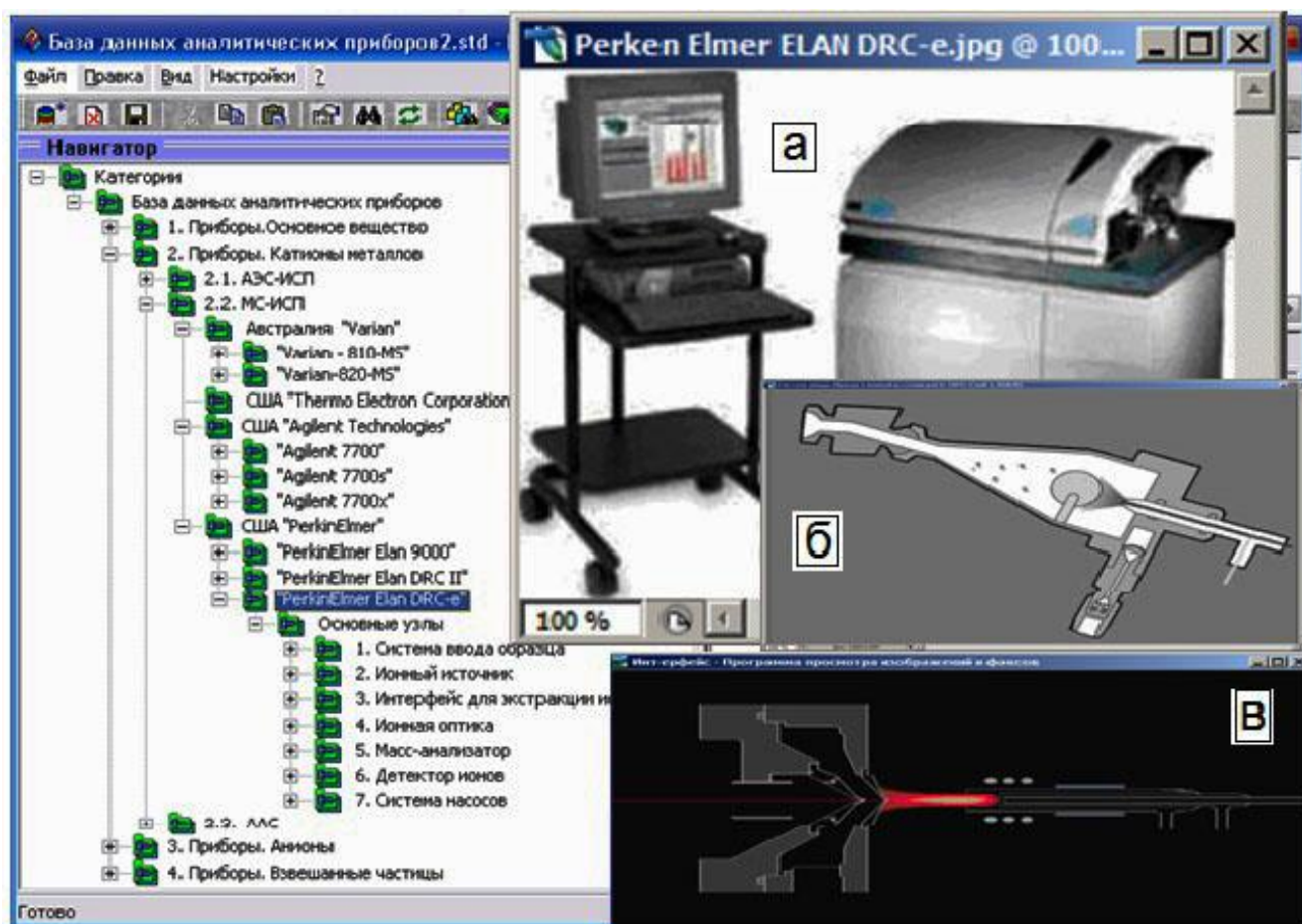
Рис. 2.6 База данных аналитических приборов. Катионы металлов. МС-ИСП: а – PerkinElmer, Elan DRC-e; б - система ввода образца; в - интерфейс для экстракции ионов
