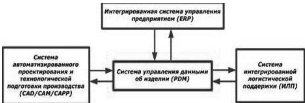
Рис. 1.11 Схема взаимодействия между различными системами, составляющими CALS
