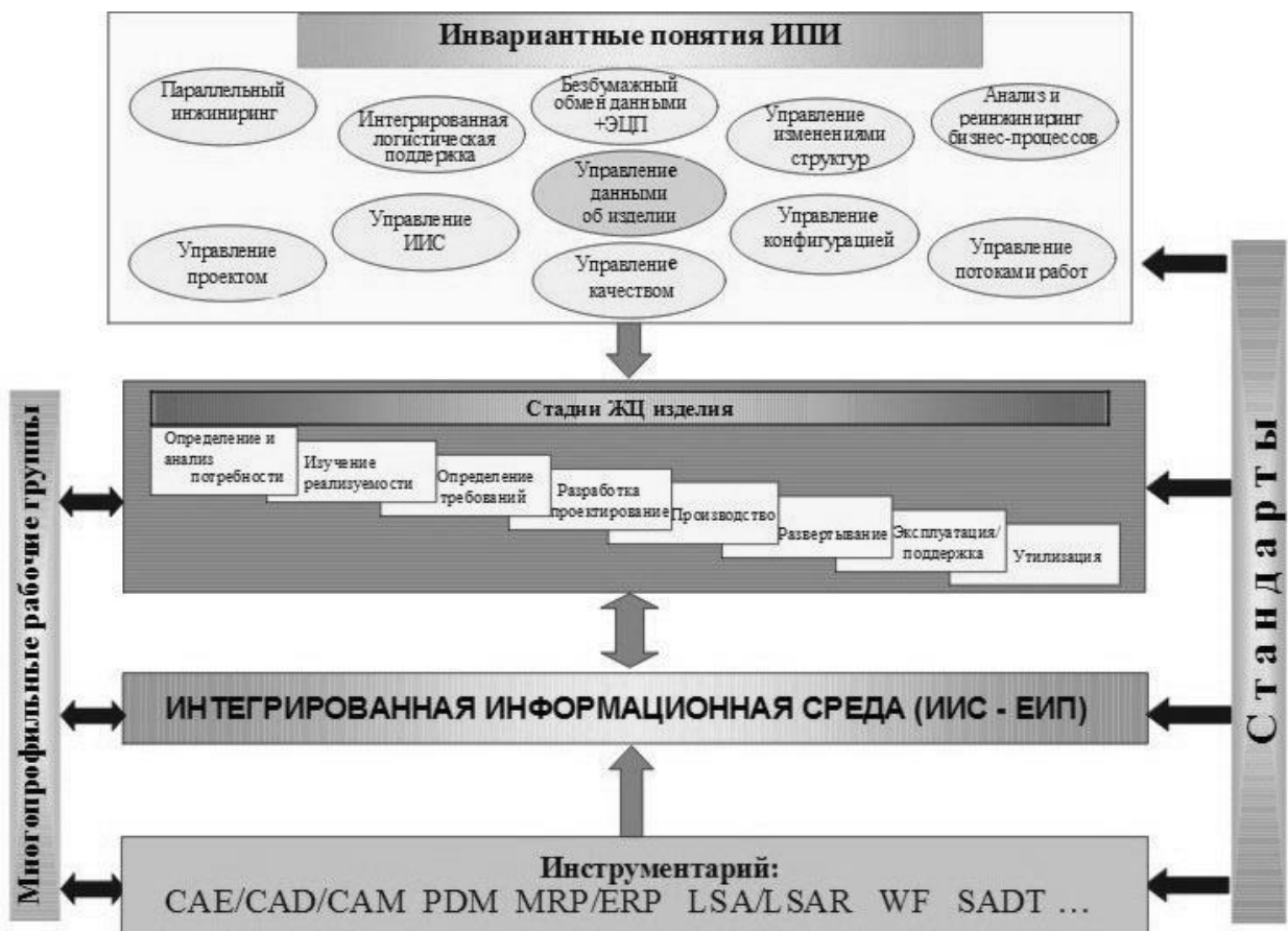
Рис. 1.10 Схема системы информационной поддержки жизненного цикла изделия (ИПИ-CALS)
