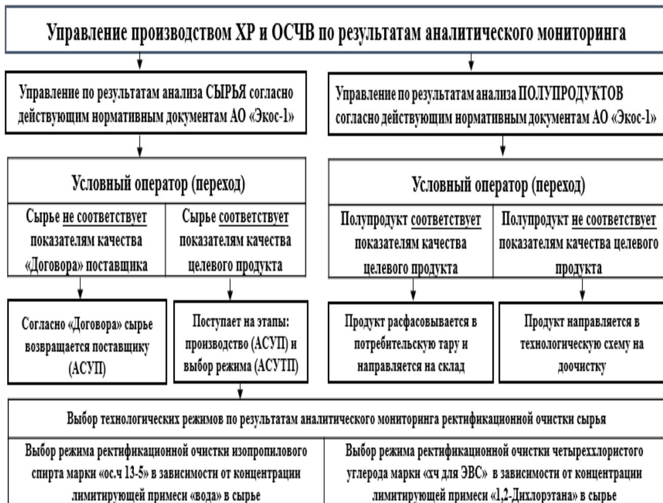
Рис. 1.6 Блок схема управления производством АО «ЭКОС-1» на основе КМК-системы органических растворителей различных квалификаций
