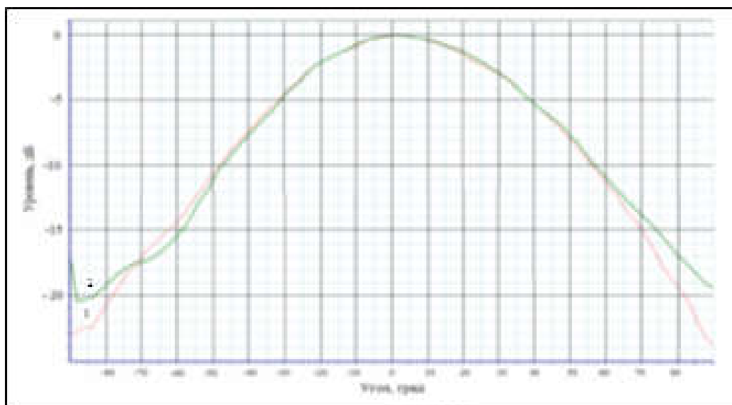
Рис. 4.3.2.3.2. Сечение диаграммы направленности антенн под обтекателем (зеленый цвет -2) и без него (красный цвет – 1) на частоте 7 ГГц
