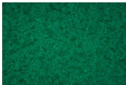
Рис. 3.4. Микрофотографии (194х) порошковых препаратов Mq в видимом свете (левая колонка) и при возбуждении УФ-светом ( \lambda_{\text{возб}} = 370 нм) (правая колонка).
