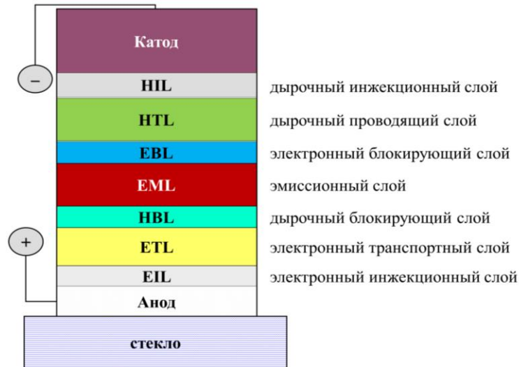
Рис. 1.5. Схема многослойной OLED-структуры.
