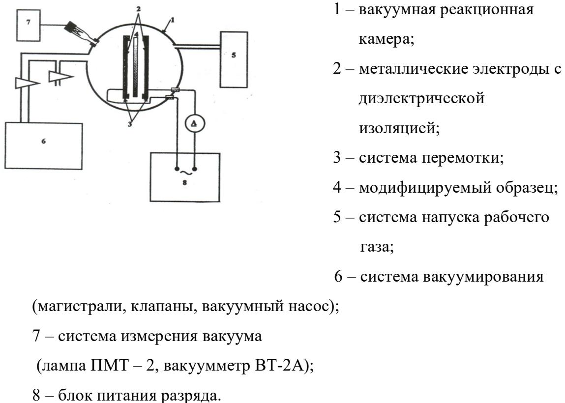
Рис. 4.1.1.1. Схема плазмохимической установки для обработки СВМПЭ тканей в НЧ – тлеющем разряде (50Гц)
