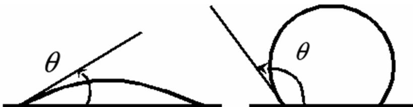
Каплю воды объемом  $\sim 0,03$  мл наносили на поверхность ткани с помощью микрошприца. Для измерения  $\theta$  использовали горизонтальный микроскоп с гониометрическим окуляром. Окуляр направляли и фокусировали, проводя измерение длины основания капли ( $2r$ ) и ее высоты ( $h$ ). По их отношению согласно специальной таблице определяли величину  $\theta$ .
