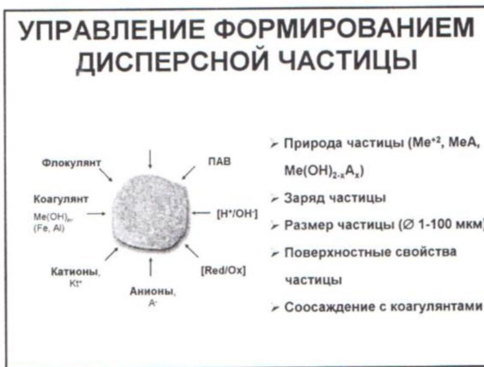
Рисунок 1.4 – Схема управления процессом формирования дисперсной частицы.
