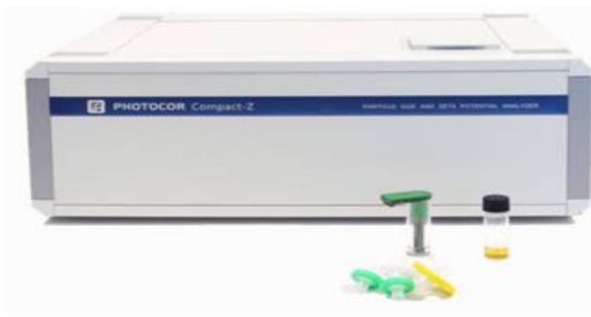
Рисунок 2.3 – Photocor Compact-Z – прибор для измерения размеров частиц,  $\zeta$ -потенциала и молекулярной массы.
