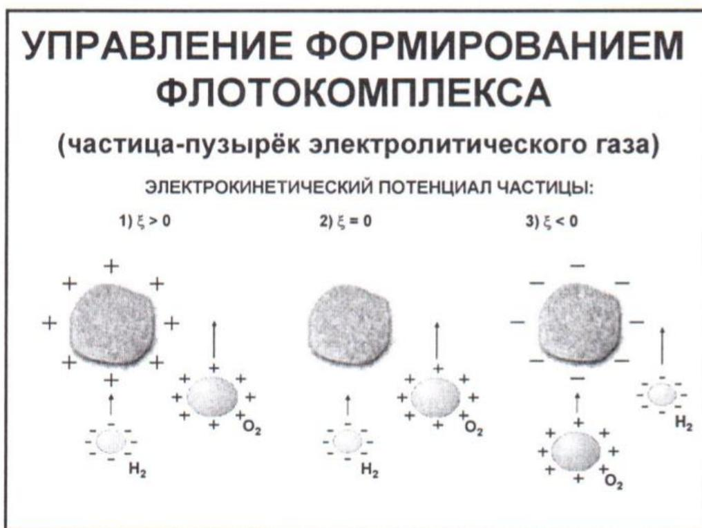
Рисунок 1.3 – Схема управления процессом формирования флотокомплекса.
