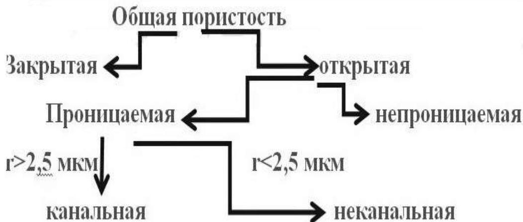
Общей или истинной пористостью называют отношение объема всех пор к общему объему образца и выражают в процентах или долях единицы. Наиболее точно общую пористость определяют по величинам истинной плотности ( $\rho$ ) и кажущейся плотности ( $\gamma$ ) по формуле:
