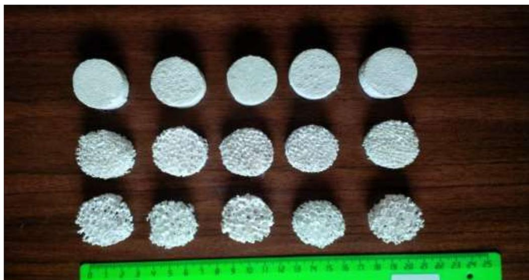
Рис. 4.3. Внешний вид высокопористых ячеистых носителей катализаторов после обжига.
