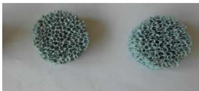
Рис. 4.15. Внешний вид полученных ВПЯМ после обжига.
