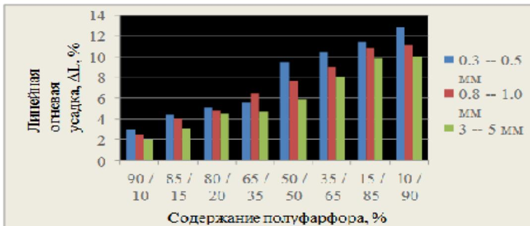
Рис. 4.14. Линейная огневая усадка образцов после  $t_{\text{обж.}} = 1350^{\circ}\text{C}$ .
