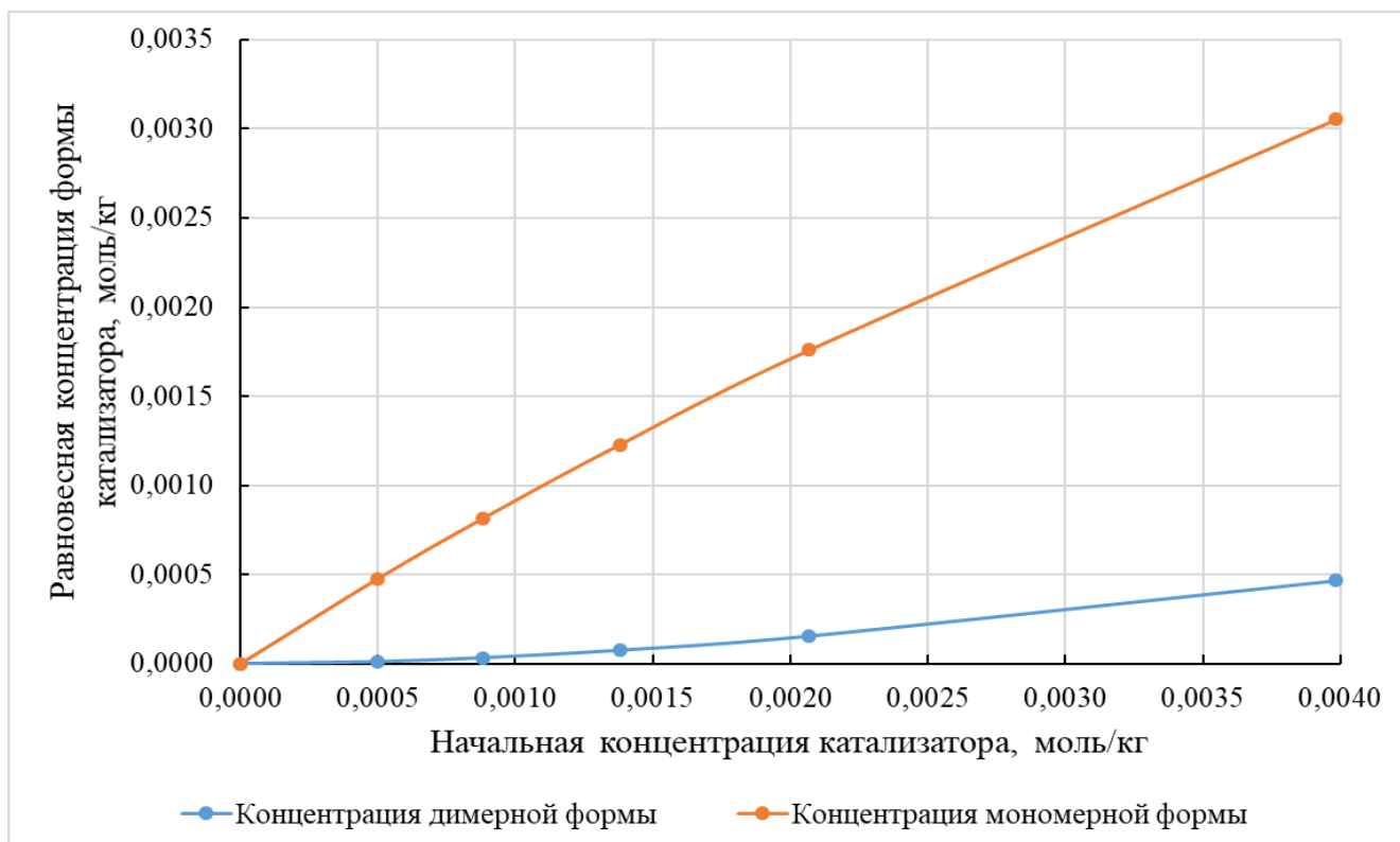
Рисунок 98 – Зависимость равновесных концентраций мономерной и димерной форм катализатора от начальной концентрации катализатора
