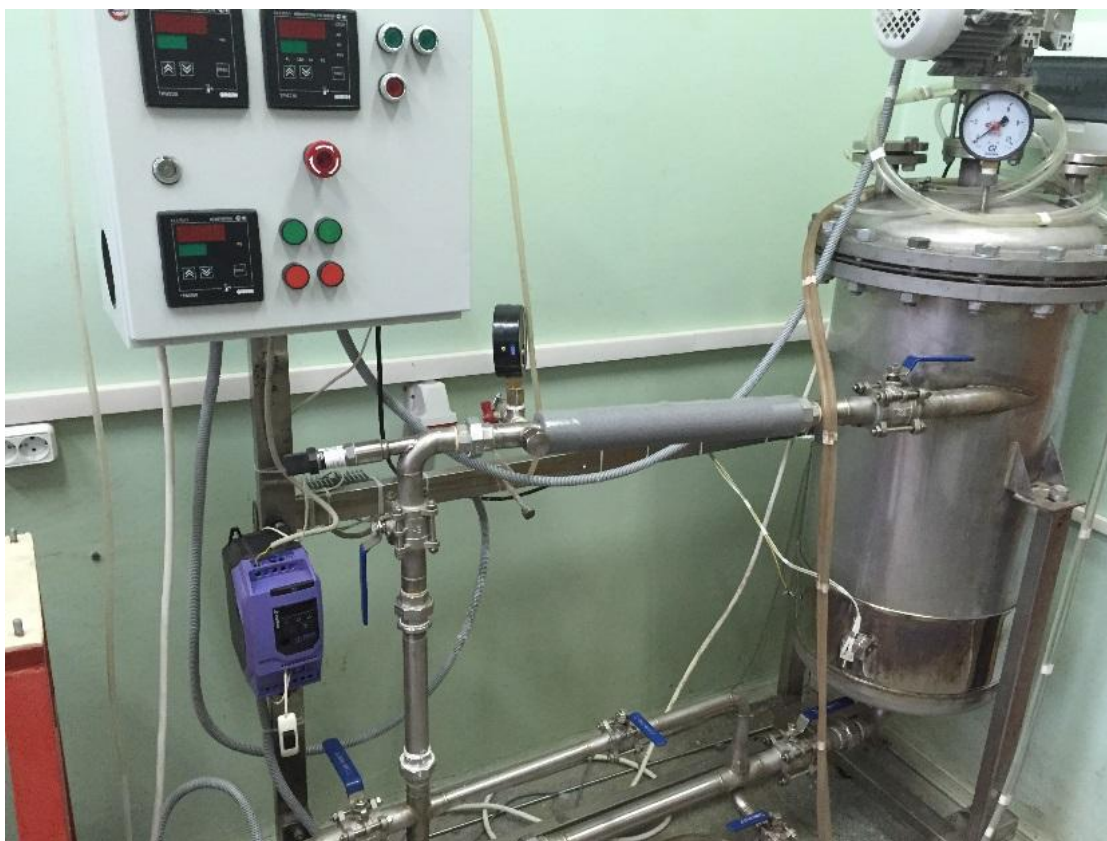
Рис. 12. Аппарат–кавитатор с соплом специальной конфигурации для интенсификации процесса выщелачивания скандия из КШ
