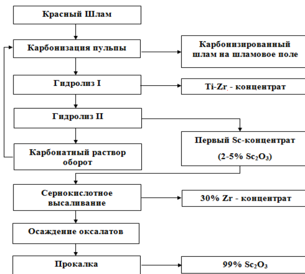
Рис. 4. Схема содощелочной переработки КШ с получением 99% Sc_2O_3 [56]
