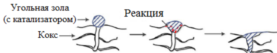
Рисунок 1.9 – Схема взаимодействия каталитической добавки и угля [91].
