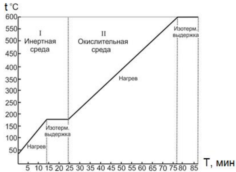
Рисунок 3.4.1 – Схематичное представление режима проведения эксперимента в синхронном термическом анализаторе.
