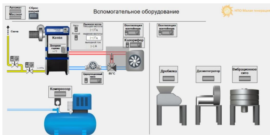
Рисунок 2.5 – Интерфейс программного обеспечения для дистанционного контроля и сбора данных, а также управления работой вспомогательного оборудования аппаратного комплекса слоевого горения энергетических углей.
