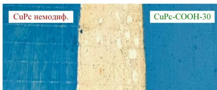
**Рисунок 3.22.** Окрасивание керамической поверхности сухими строительными красками на основе немодифицированного пигмента (слева) и CuPc-COOH-30 (справа).
