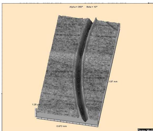
Рисунок 5.20 Треки износа стальных дисков после трибологических испытаний композиции  $ZnO-WS_2$  при  $400^\circ C$  на воздухе
