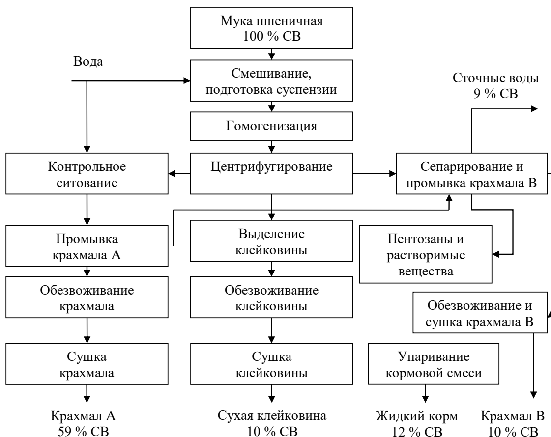
Рисунок 4. Принципиальная технологическая схема переработки пшеничной муки [97]
