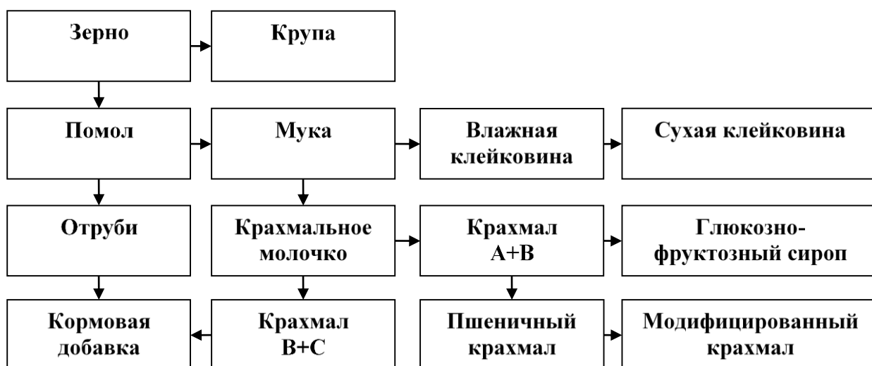
Рисунок 2. Пример схемы глубокой переработки зерновых культур [95]
