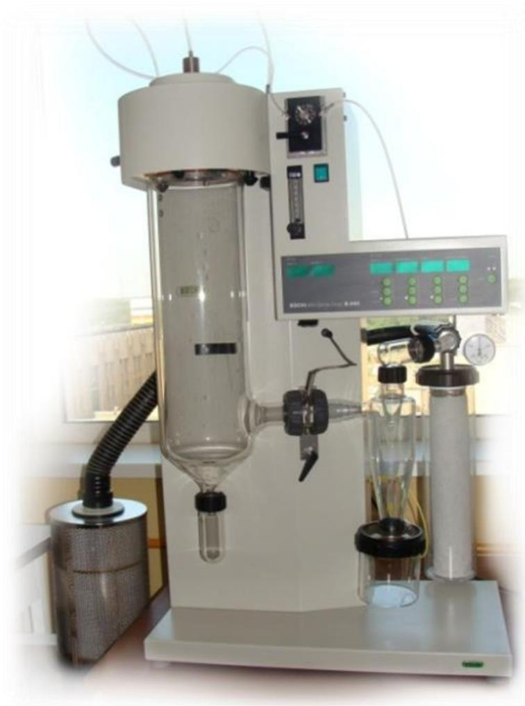
Рисунок 12. Установка распылительной сушки, фирма BUCHI
