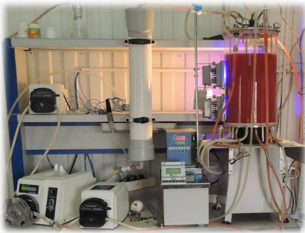
Рисунок 11. Комплекс для высокоплотного культивирования галобактерий.
