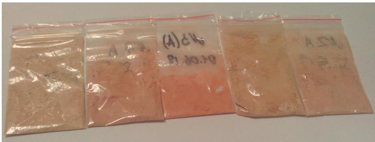
Рисунок 13. Образцы биомассы, полученные после распылительного высушивания
