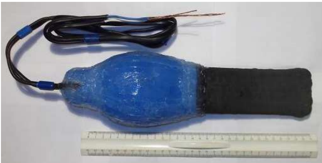
Рис. 5.2.1.6. Образец нерастворимого анода \text{PbO}_2/\text{Ti} для промышленных целей (длина линейки 30 см).
