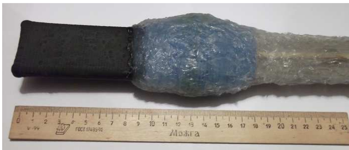
Рис. 5.2.1.5. Образец нерастворимого анода PbO_2/Ti для промышленных целей.
