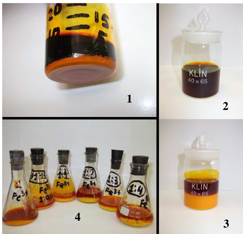
Рис. 4.6.2.1. Удаление катионов трехвалентного железа из электролита хромирования, его концентрата и разбавленных растворов с помощью йодноватой кислоты при нагреве при t=60-80^{\circ}\text{C} в течение суток. Йодноватая кислота позволяет извлекать катионы трехвалентного железа: 1 - из концентратов электролита хромирования, 2, 3 - из электролита хромирования (фото до и после осаждения ионов \text{Fe}^{3+} ) и 4 - из разбавленных электролитов хромирования.
