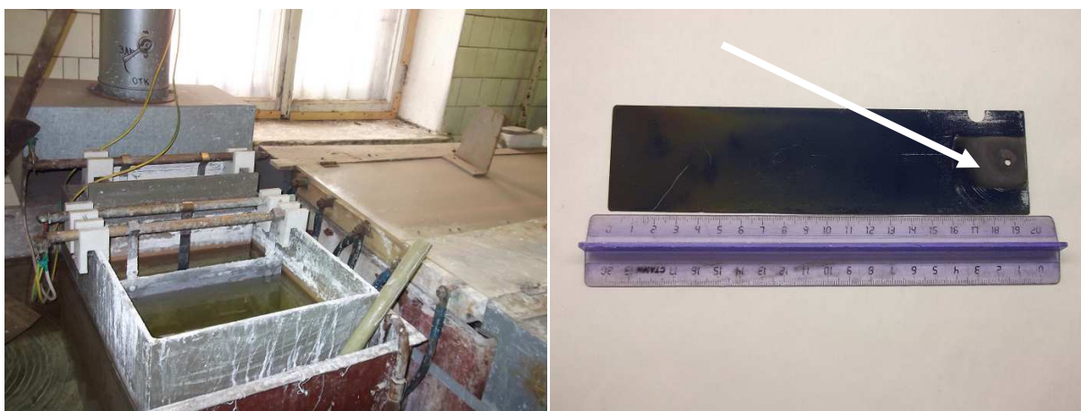
Рис. 5.1.2. Слева: - мембранный электролизер для удаления CN^- из производственной ванны улавливания для цинкования в цианистом электролите. Справа: - в процессе удаления CN^- из ванны улавливания анод Pt/Ti полностью вышел из строя. Pt покрытие осталось только под местом электрического контакта (указано белой стрелкой).
