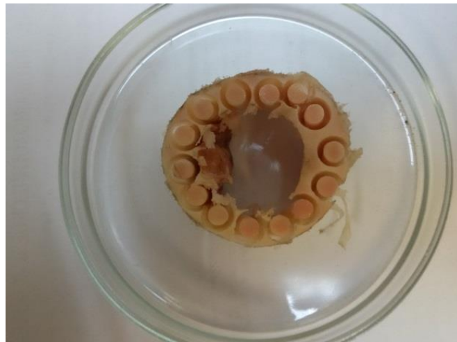
Рисунок 18 - Фрагмент диафиза бедренной кости быка с высверленными заготовками цилиндрической формы
