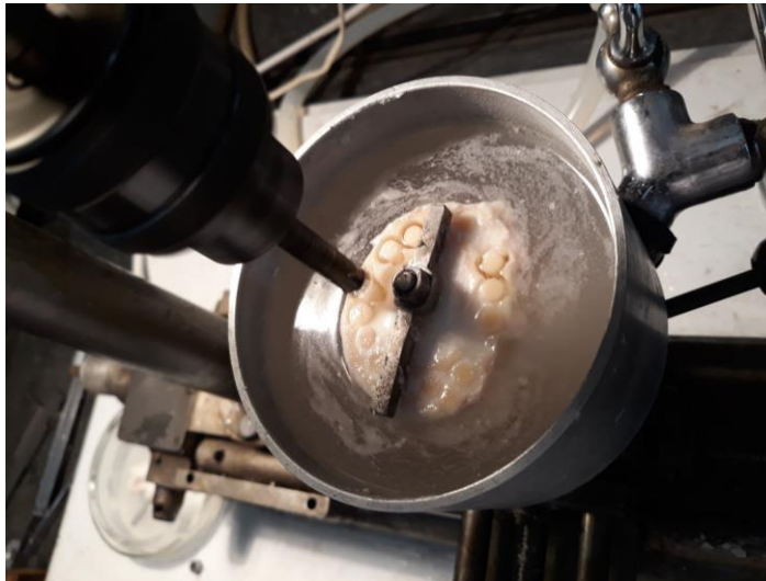
Рисунок 17 - Получение заготовок имплантатов с анизотропией продольной ориентации с использованием полый цилиндрической фрезы
