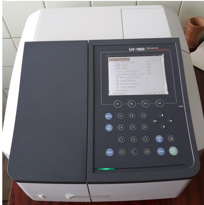
Рисунок 15 - Спектрофотометр UV-1800 SHIMADZU
