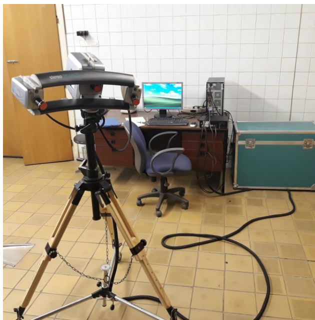
Рисунок 12 - Прецизионный 3D-Stereoscan 5МП
