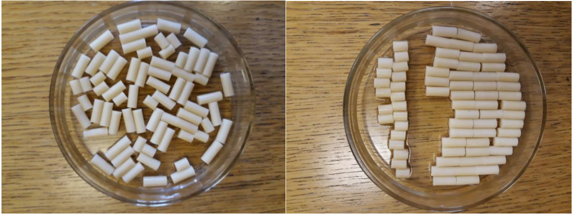
Рисунок 21 - Цилиндрические образцы костных имплантатов 12,5x5 мм и 7,5x5 мм с обработанными торцами
