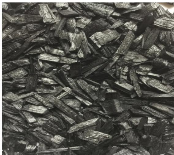
**Рис. 11. Внешний вид фрагментов карбонизата древесины железного дерева**
