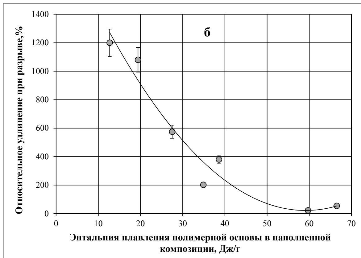
Рисунок 3.4. Зависимости прочности (а) и разрывной деформации (б) композиций с 50 масс. % мела от энтальпии плавления полимеров в наполненных композициях
