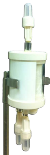
Рис. 13. Опытный образец спирального плазмофильтра в собранном виде. Плазмофильтр установлен в держатель экспериментального стенда.
