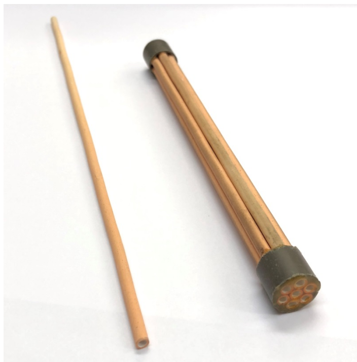
Рис. 4. Трубчатая керамическая микрофльтрационная единица – слева, мембранный модуль из 7 объединенных вместе единиц – справа [91, 92].
