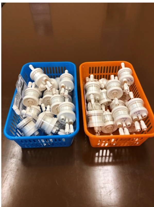
Рис.14. Различные опытные образцы спирального плазмофильтра, изготовленные для экспериментального поиска оптимальных параметров конструкции.
