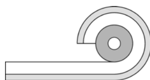
Рис. 35. Часть витка мембранного пакета, намотанного на коллектор плазмы.
