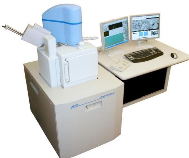
Рисунок. 2.9 - Микроскоп JEOL 1610LV
