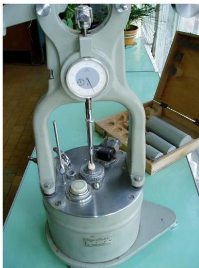
Рисунок 2.4 – консистометр Хепплера
