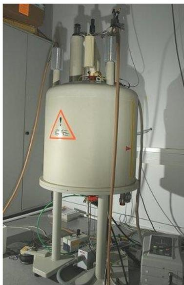
Рисунок 2.6 – Прибор Bruker 200 МГц NMR
