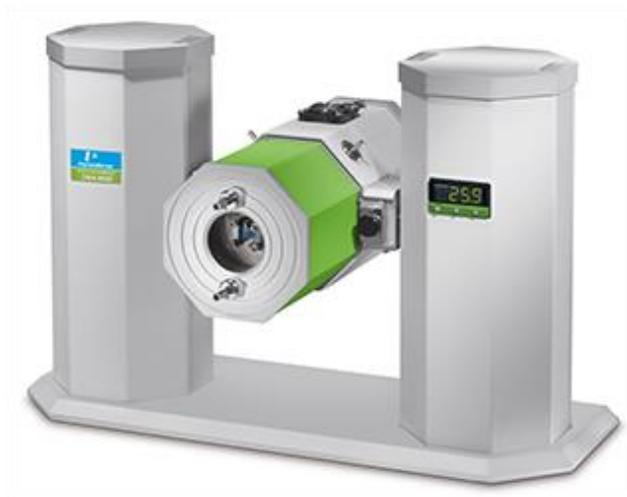
Рисунок 2.7- Прибор Perkin Elmer DMA8000
