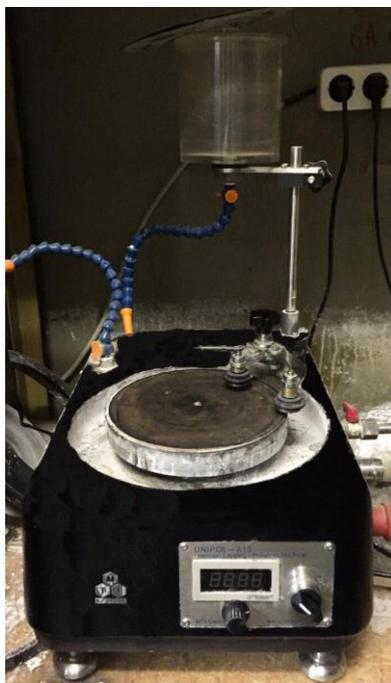
Рисунок 13. Станок для шлифовки и полировки Unipol-810 (MTI Corporation, США).
