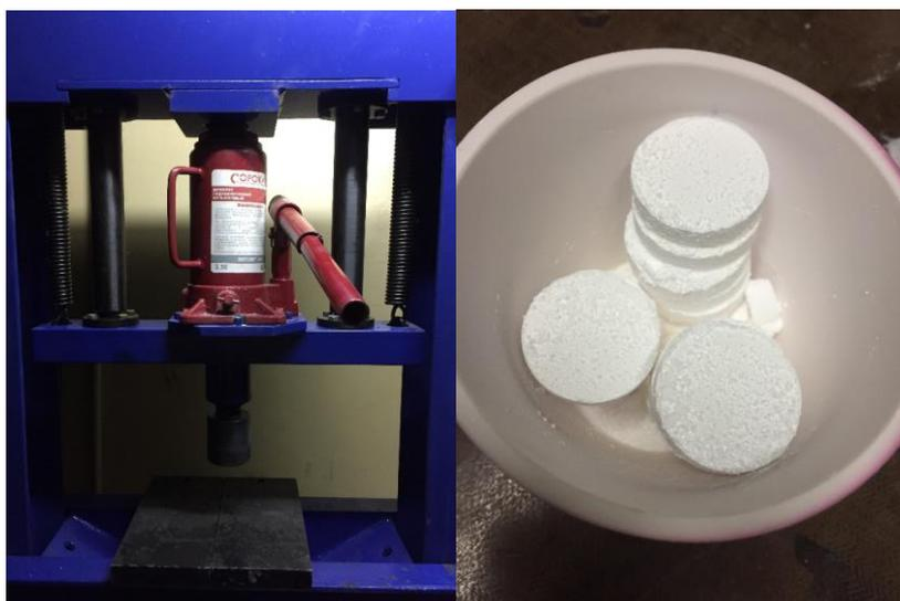
Рисунок 9. Фото гидравлического пресса и шихты, спрессованной в таблетки.
