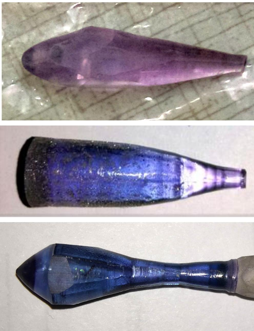
Рисунок 34. Примеры фотографий оптически прозрачных однофазных кристаллов хром-форстерита 2-й серии.
