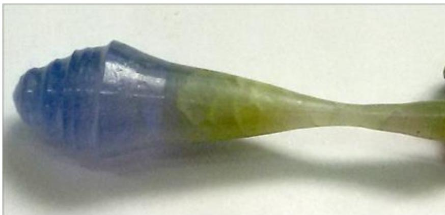
Рисунок 31. Фото образца «Кр.1», выращенного из строго-стехиометрического расплава и содержащего включения побочных фаз.
