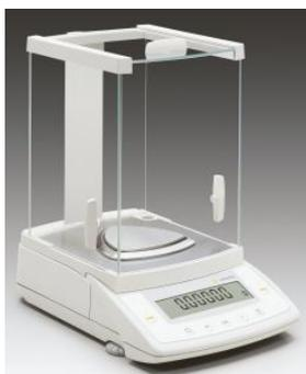
Рисунок 8. Полумикровесы Sartorius CPA225D-0CE
