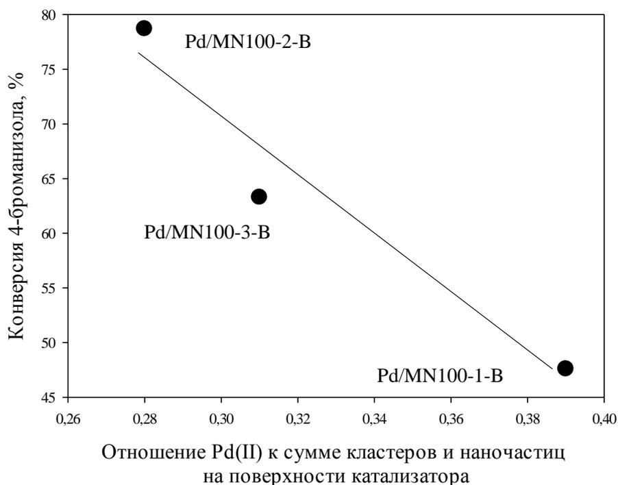
Рисунок 3.23 - Зависимость конверсии 4-броманизола от отношения Pd(II) к сумме кластеров и наночастиц на поверхности восстановленного катализатора
