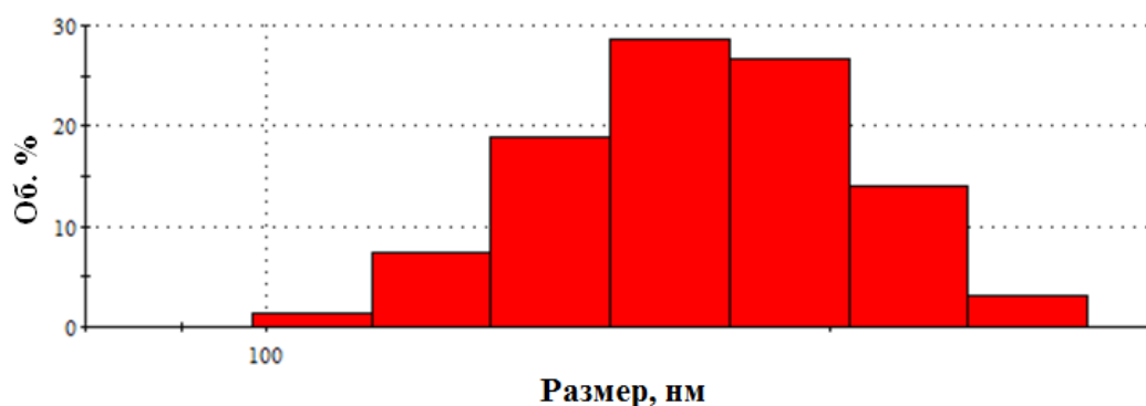
Рисунок 3.52 – Гистограмма распределения наночастиц по размерам суспензии, полученной методом Штобера
