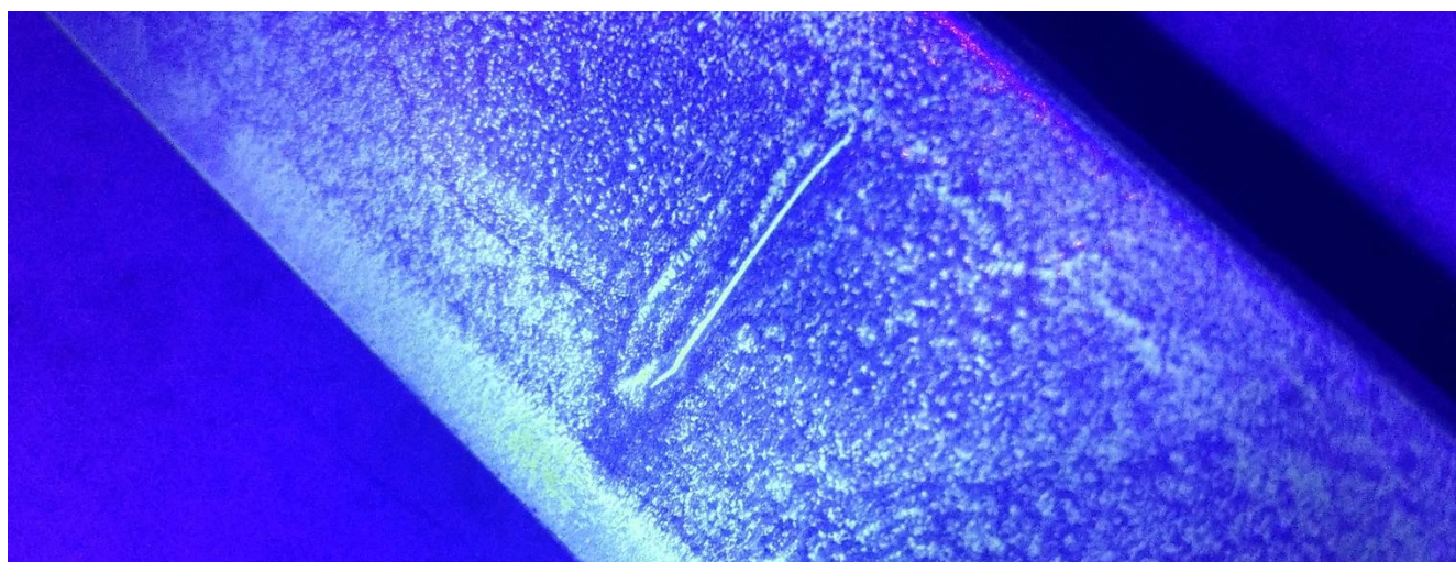
Рисунок 3.76 – Фотография выявленного дефекта на эталонном образце класса А люминесцентной магнитной суспензией «Элитест ЛС4»
