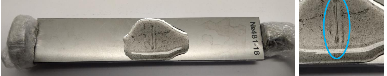
Рисунок 3.77 – Фотография выявленного дефекта на эталонном образце класса А суспензией композиционных наночастиц
