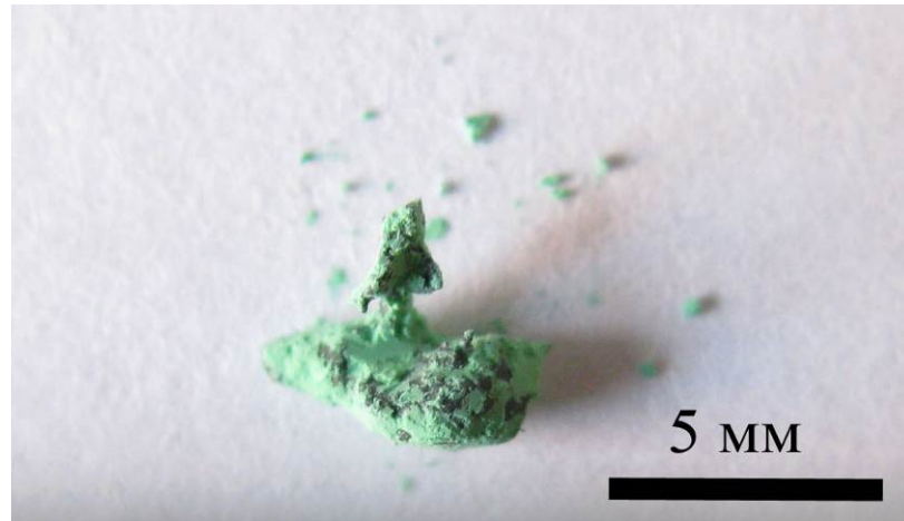
Рисунок 3.4 – Микрофотография инородного включения, облепленного частицами ОТФУ2
