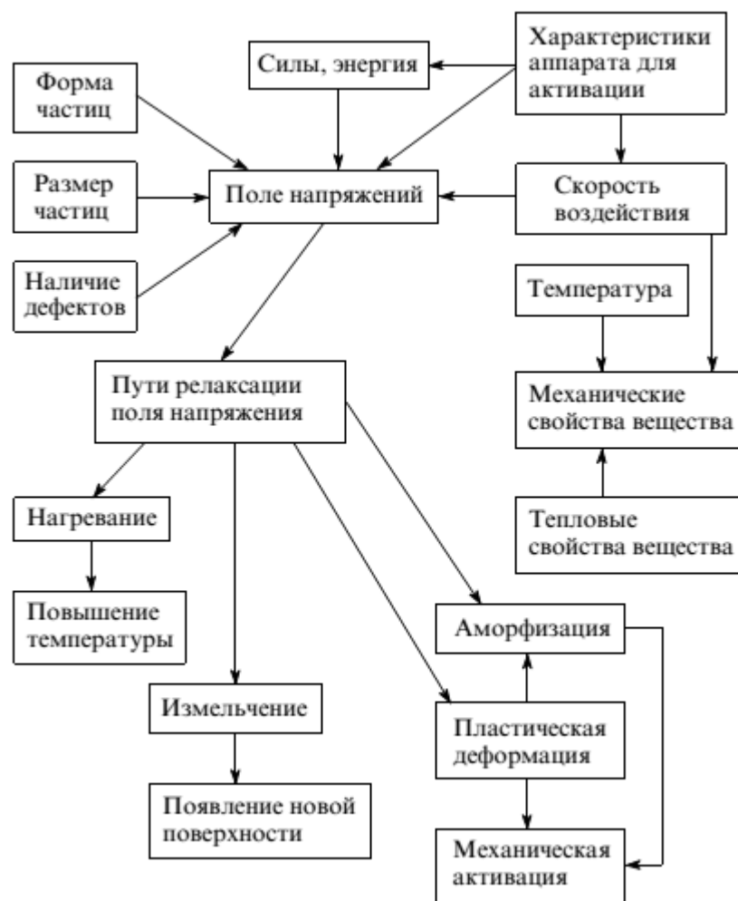
Рисунок 1.6 – Факторы формирования поля напряжений и пути релаксации в веществах при измельчении и механической активации [45]
