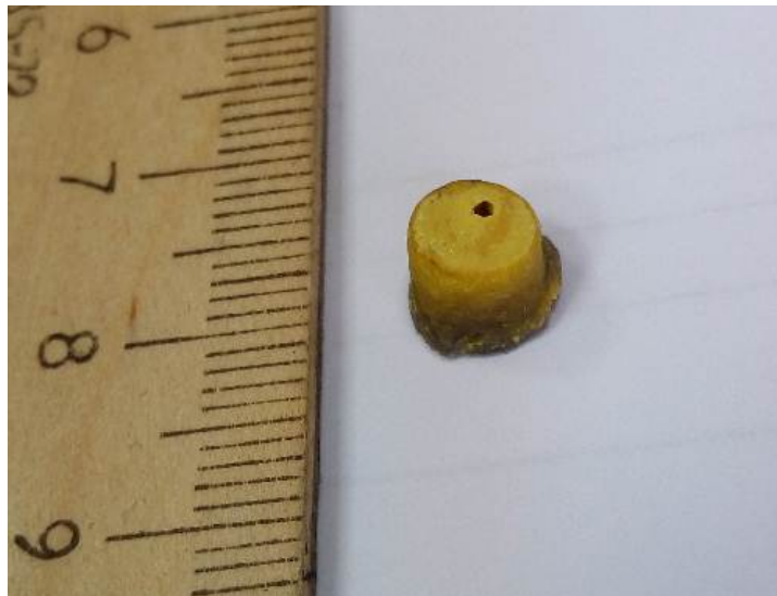
Рисунок 3.60 – Внешний вид продукта взаимодействия ( 575^\circ\text{C} ) в воздушной среде (после шлифовки поверхности) ОТФУ с кварцем, активированным в присутствии \text{NaF} (30% масс.)
