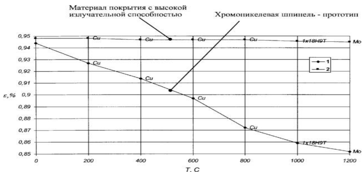
Рис. 1.15. Зависимость излучательной способности хромита никеля от температуры.
