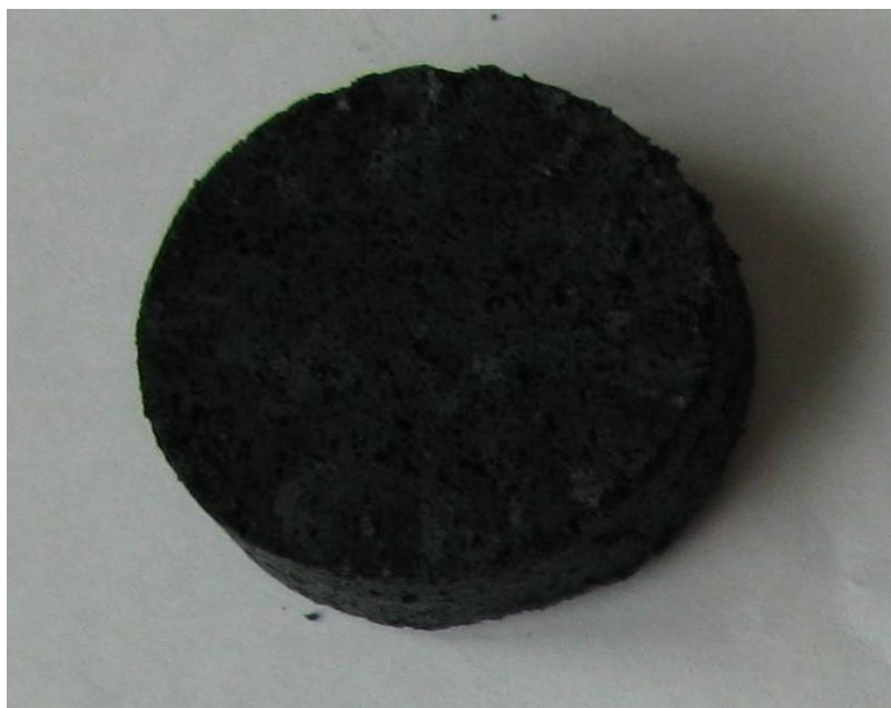
Рис. 3.30. Внешний вид продукта спекания (70% \text{NiCr}_2\text{O}_4 – 30% \text{NaCl} ) при 900 °С.
