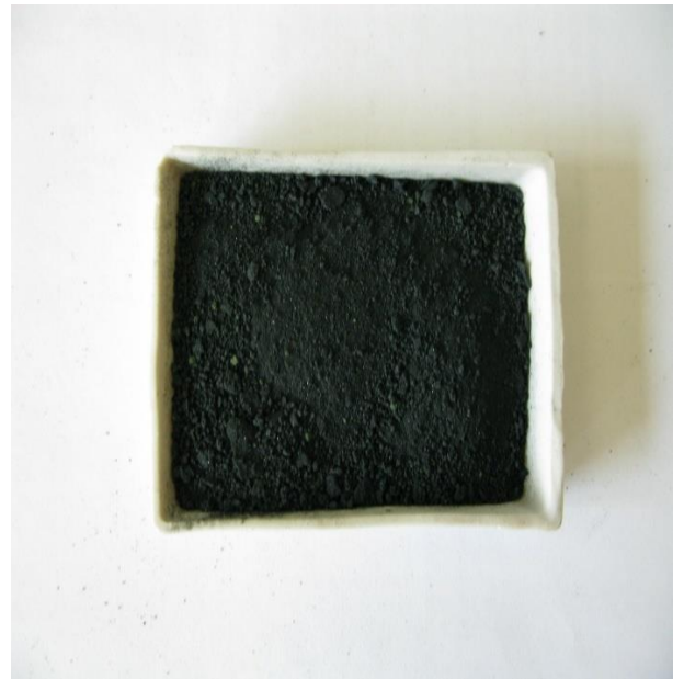
Рис. 2.5. Вид кристаллического порошка \text{NiCr}_2\text{O}_4 .
