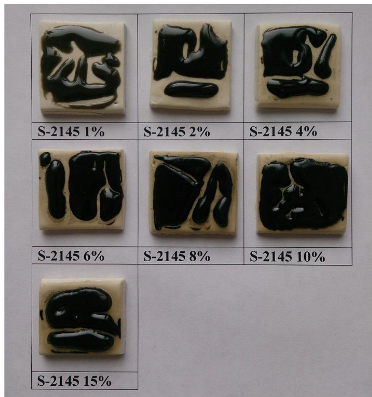
Рис. 6.14. Внешний вид обожжённой глазури (S-2145, при нанесении 1 мл).
