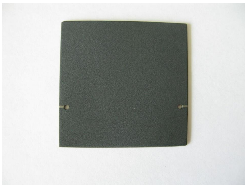
Рис.6.1. Внешний вид покрытия на основе синтезированной хромоникелевой шпинели \text{NiCr}_2\text{O}_4 , нанесенной методом плазменного напыления.
