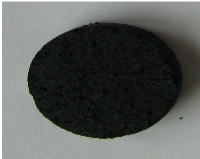
Рис. 3.10. Внешний вид таблетки \text{NiCr}_2\text{O}_4 + \text{CaCl}_2 после спекания.
