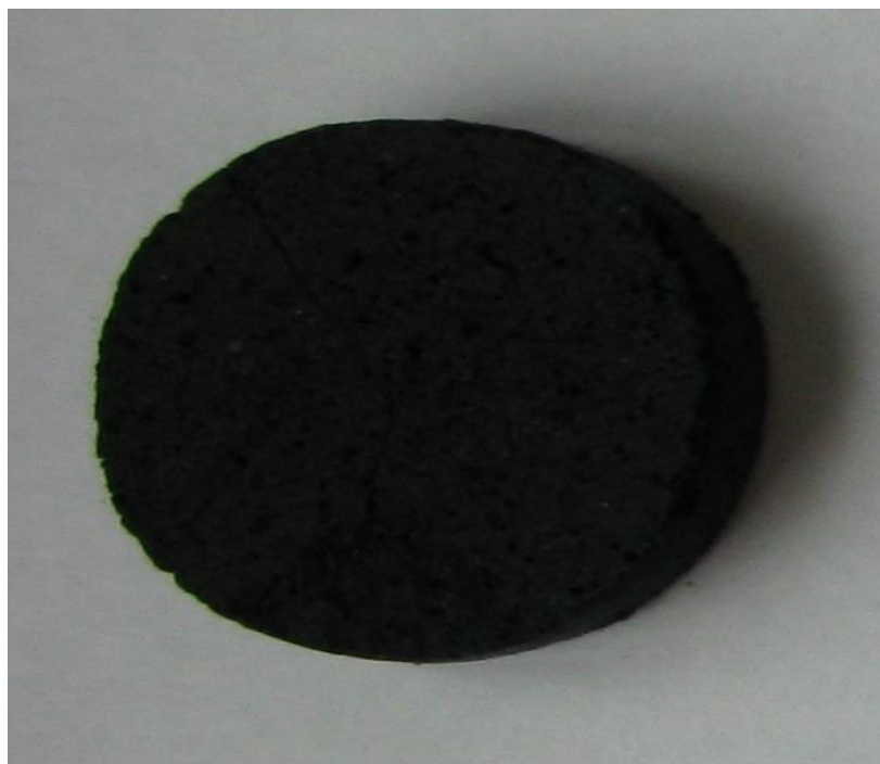
Рис. 3.35. Внешний вид продукта спекания (70% \text{NiCr}_2\text{O}_4 – 30% \text{NaCl} ) при 950 °С.
