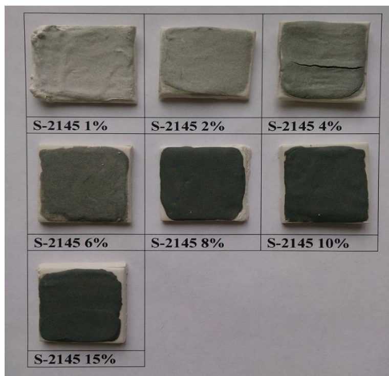
Рис. 6.13. Внешний вид образцов экспериментальных глазурей на основе пигмента хромоникелевой шпинели заданного концентрационного ряда при нанесении 1 мл капли глазури.
