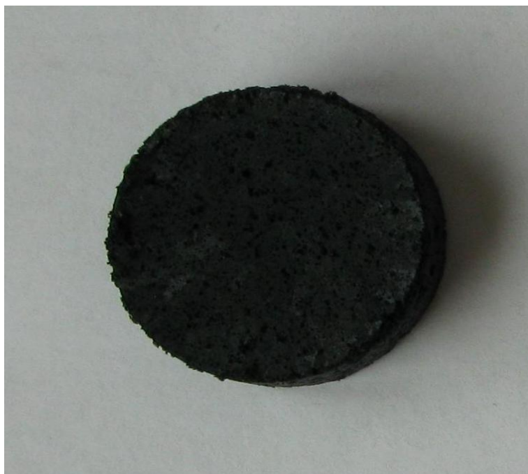
Рис. 3.7. Внешний вид таблетки \text{NiCr}_2\text{O}_4 + \text{Li}_2\text{MoO}_4 после спекания.
