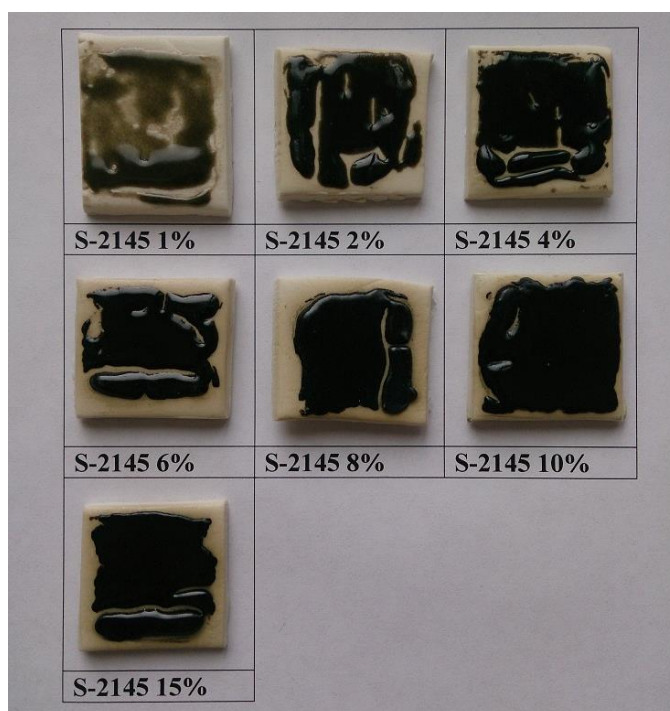
Рис. 6.12. Внешний вид обожжённой глазури (S-2145, при нанесении 0,5 мл глазури).
