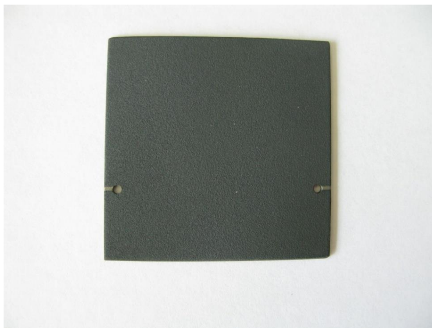
Рис.2.6. Внешний вид покрытия на основе синтезированной хромоникелевой шпинели нанесенной плазменным методом.
