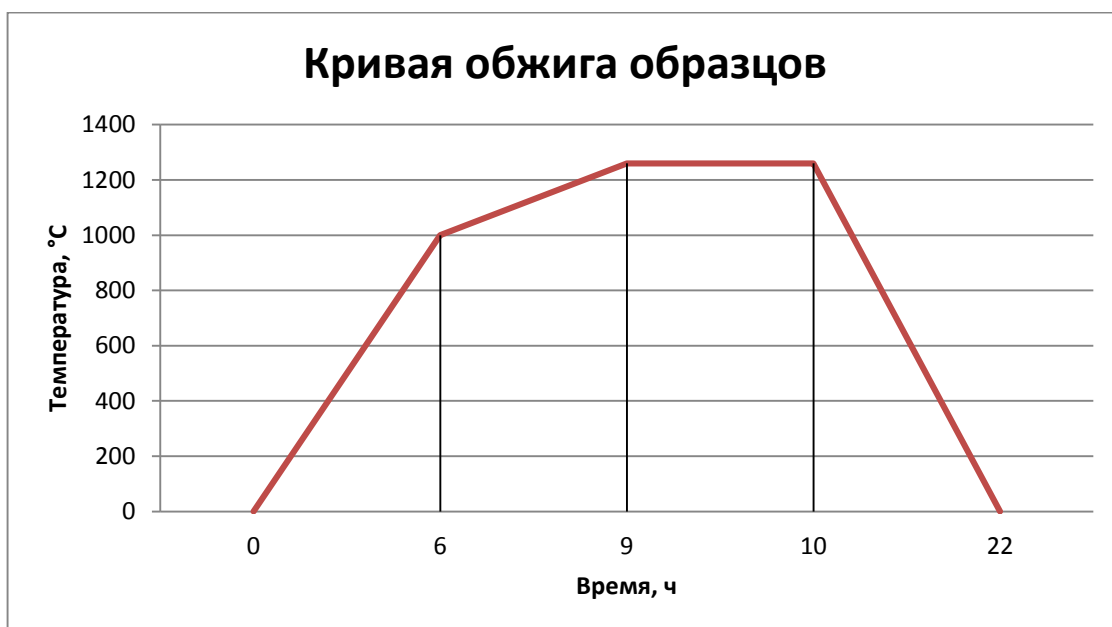
Рис.2.8. Температурный режим обжига образцов на основе глазури S-2145 (S-0145).
