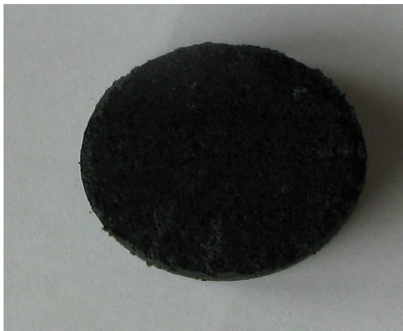
Рис. 3.43. Внешний вид продукта спекания (70% \text{NiCr}_2\text{O}_4 – 30% \text{NaCl} ) при 1050 °С.
