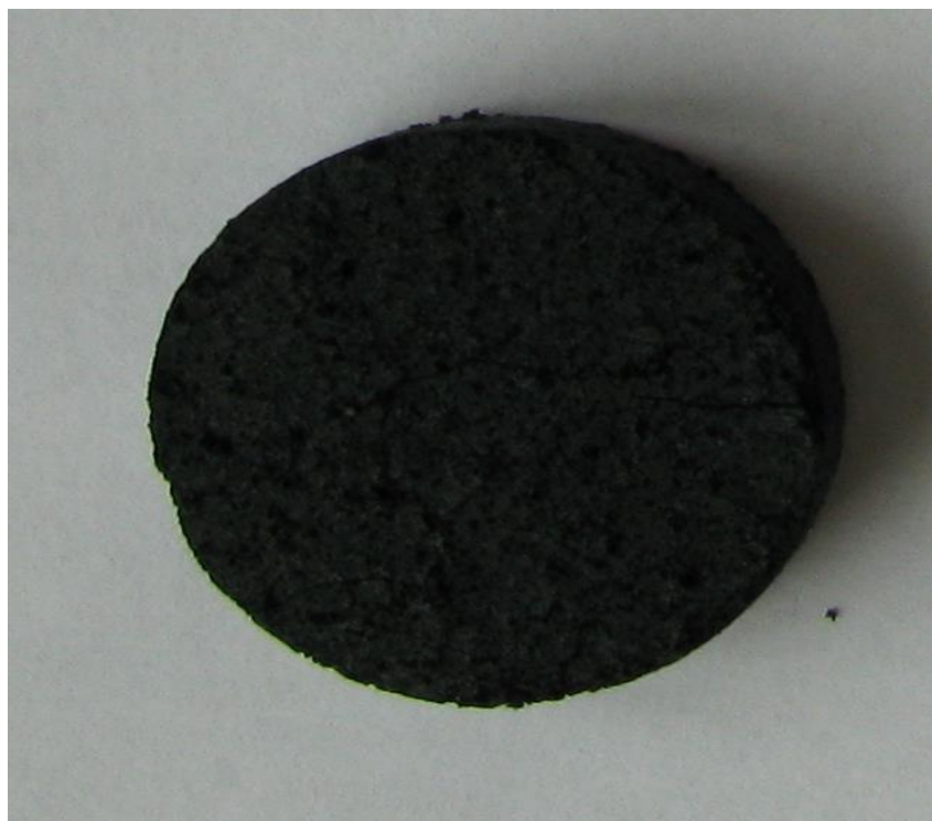
Рис. 3.39. Внешний вид продукта спекания (70% \text{NiCr}_2\text{O}_4 – 30% \text{NaCl} ) при 1000 °С.
