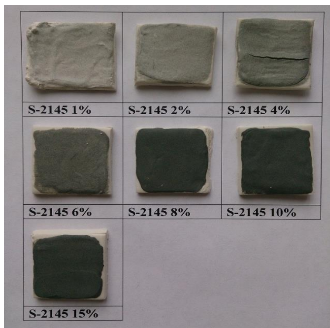
Рис. 6.11. Внешний вид образцов экспериментальных глазурей на основе пигмента хромоникелевой шпинели заданного концентрационного ряда при нанесении 0,5 мл капли глазури (до обжига).
