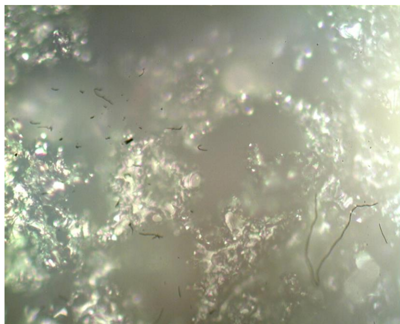
Рис. 3.44. Морфология поверхности спека (70% \text{NiCr}_2\text{O}_4 – 30% \text{NaCl} ) при 1050 °С.
