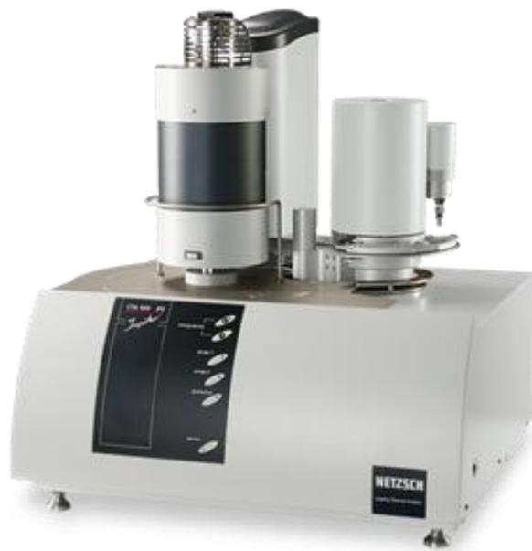
Рис. 23. Синхронный термоанализатор STA 449 F5 Jupiter.
