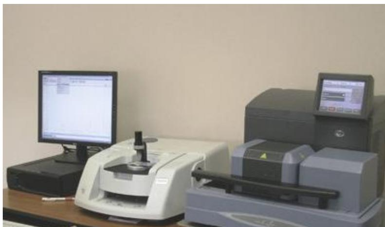
Рис.21.Спектрометр Nicolet 380
