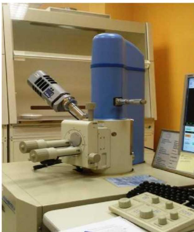
Рис.22. СЭМ JEOL JSM-6510LV
