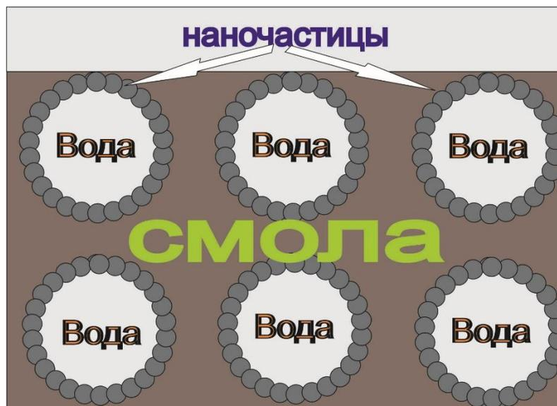
Рис.41. Структура обратной эмульсии вода/НПЭС, содержащей наночастицы
