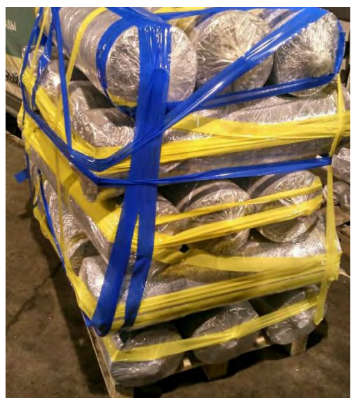
Рис. 3.18 Внешний вид блоков насадки РЛВН, упакованных согласно техническим требованиям
