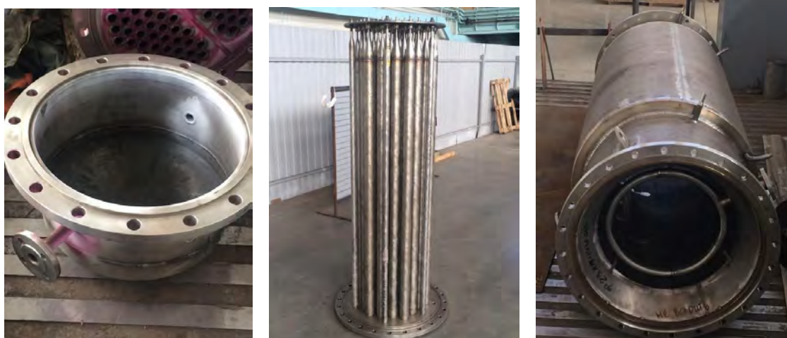
Рис. 3.189 Внешний вид составных частей испарителя (нижний узел обращения потоков)
