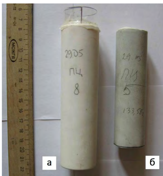
Рис. 4.2. Типичный вид исследуемых образцов: а – формовочный тигель с отверждаемым образцом; б – отвержденный образец
