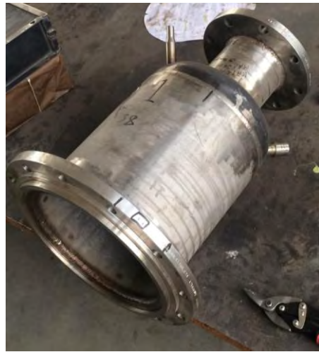
Рис. 3.17 Внешний вид составных частей ректификационной колонны
