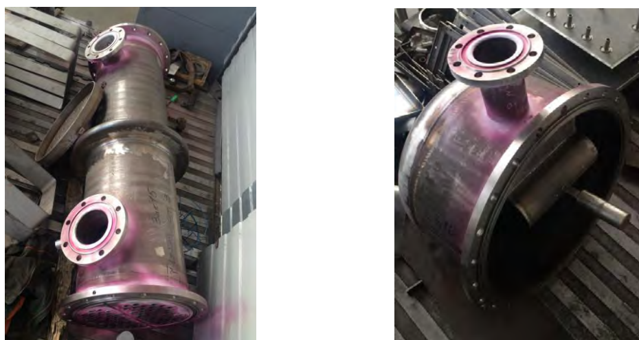
Рис. 3.20 Внешний вид составных частей конденсатора (верхний узел обращения потоков)
