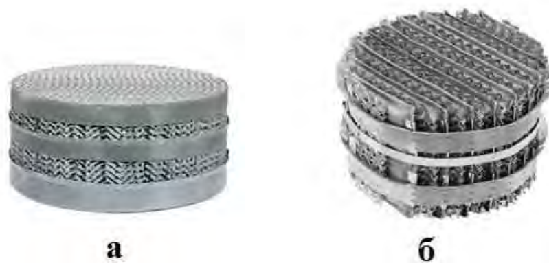
Рис. 1.19. Элементы насадки фирмы Sulzer [273]: а - СУ-типа, гладкий бандаж; б - Katarak-SP, бандаж с «лепестками»
