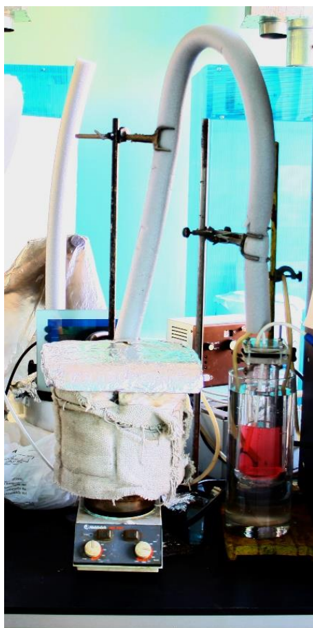
Рис. 2.3 Фотография (слева) и схема устройства (справа) установки для получения насыщенного раствора. 1 – емкость для вымешивания, 2 - фильтр, 3 – фильтрующая заглушка, 4 – грибовый фланец, 5 приемник раствора, 6 – штуцер системы откачки, 7 – подогреваемая трубка.
