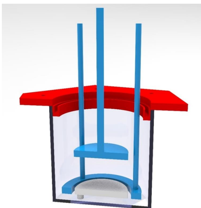
Рис. 2.9 Схема кристаллизатора для выращивания кристаллов с применением осциллирующего диска в разрезе.
