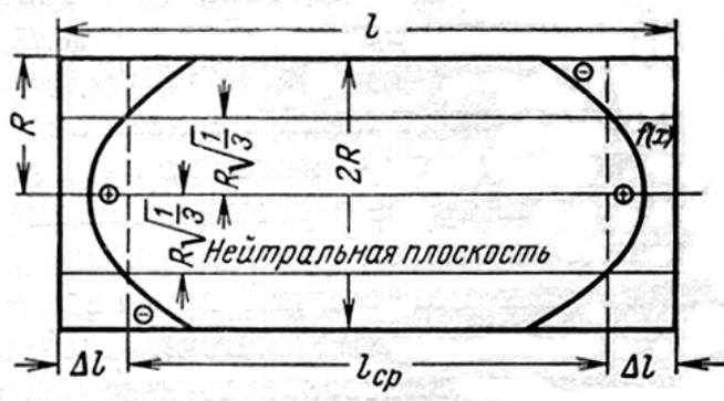
Рисунок 3.29 – Распределение напряжений при сушке в образце в виде пластины неограниченной длины шириной  $l$  и толщиной  $2R$  [315, С. 194]
