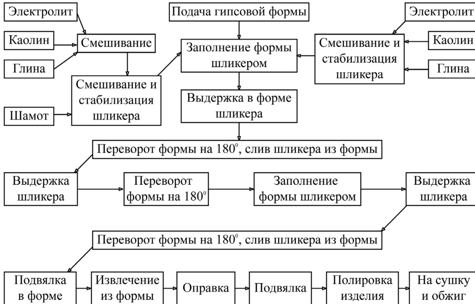
Рисунок 3.79 – Технологическая схема изготовления полых керамических мешалок с покрытием
