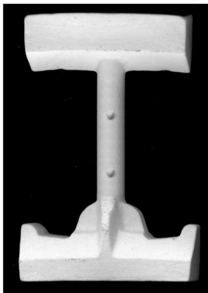
Рисунок 3.55 – Внешний вид образцов после спекания при максимальной температуре 1200 °С
