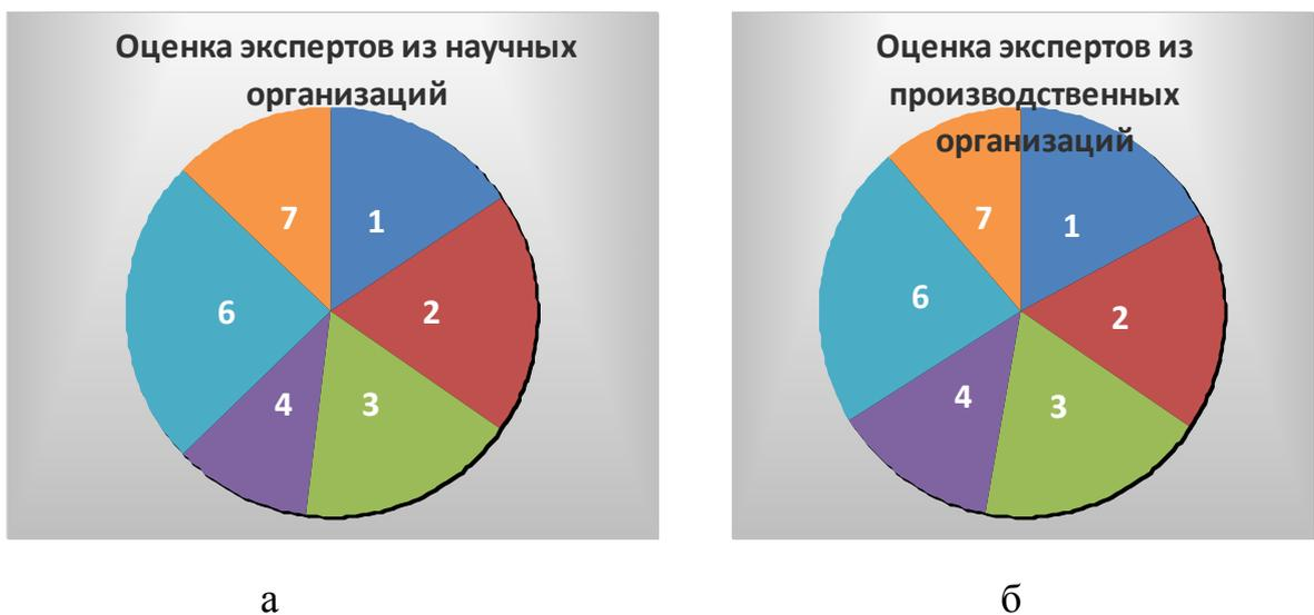
Рисунок 2.17 – Результаты опроса экспертов научных (а) и производственных (б) фирм о влиянии стадий производства керамических изделий на получение бездефектного изделия. 1 – рецепт массы; 2 – подготовка формовочной массы; 3 – формование; 4 – сушка; 5 – обжиг; 6 – обработка, полуфабриката, включая декорирование
