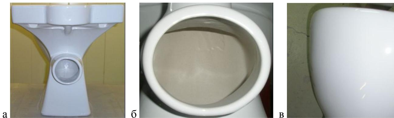
Рисунок 3.48 – Виды деформаций при обжиге унитазов: а – деформация под собственным весом (отклонение от горизонтали); б – деформация сливного отверстия (овальность); в – прогиб стенки в результате неравномерной усадки
