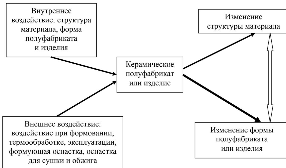
Рисунок 2.18 – Схема взаимосвязей структуры материала и формы изделия при внешних и внутренних воздействиях
