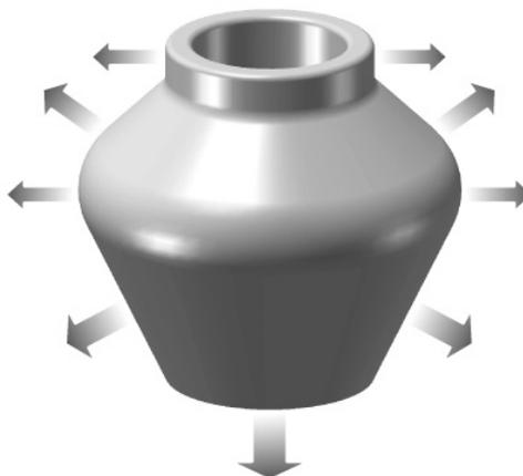
Рисунок 2.28 – Осевая симметрия (симметрия покоящегося шара) формовочных усилий при шликерном литье в пористые формы
