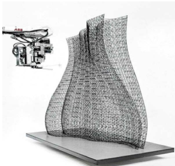
Рисунок 1.20 – Сетчатая конструкция для бетонного строительства и элемент головки робота для ее создания методом АТ [124, С. 58]
