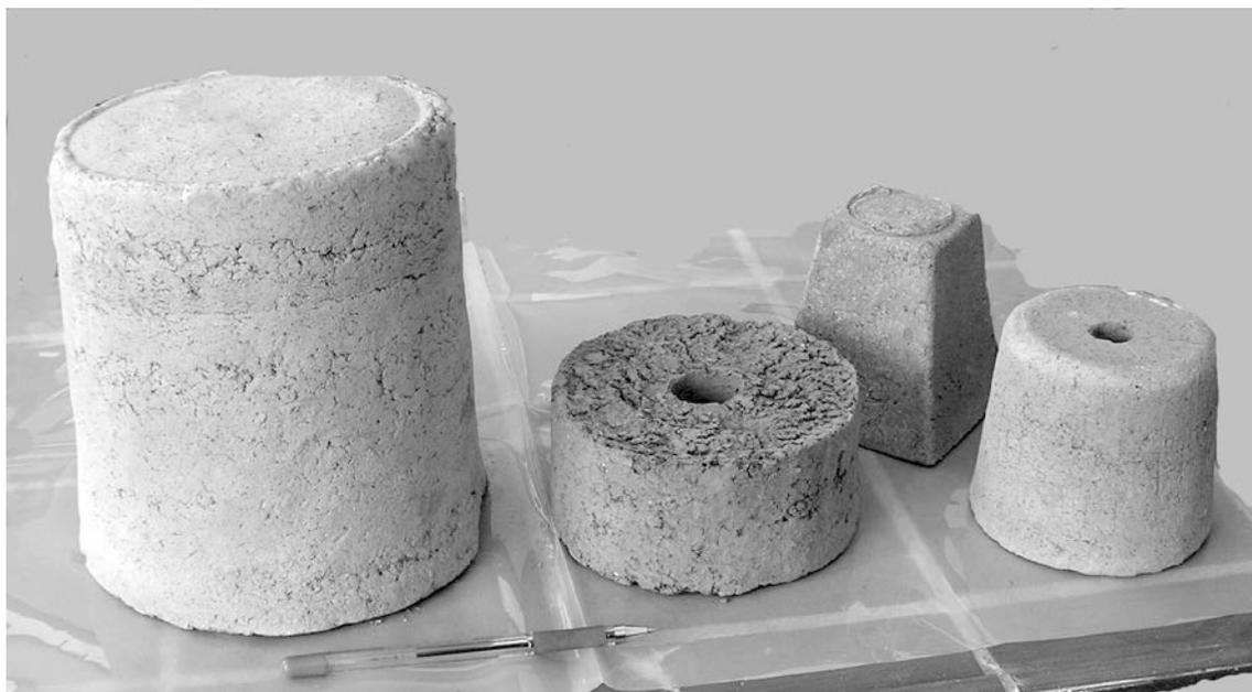
Рисунок 3.66 – Изделия различной формы, изготовленные из пористой керамики
