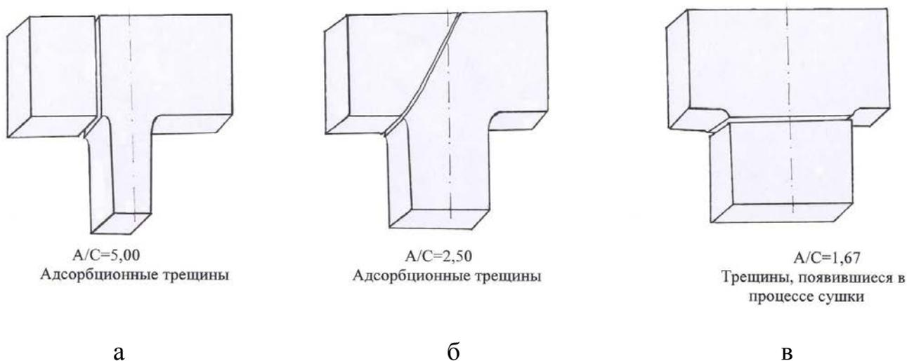
Рисунок 3.45 – Расположение трещин на фигурных пластинах при различных соотношениях между широкой (А) и узкой (С) частями: а – 5; б – 2,5; в – 1,67
