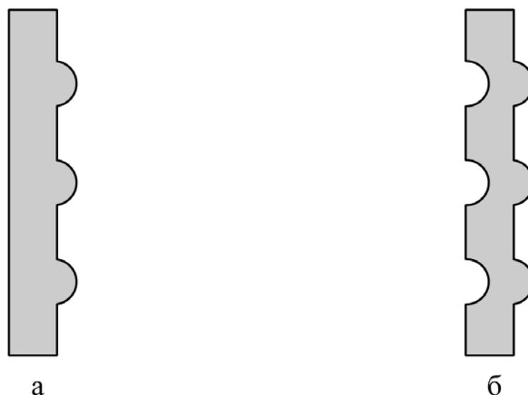
Рисунок 2.6 – Выравнивание фактора формы различных частей изделия за счет выравнивания толщины изделия. а – форма до коррекции, б – после внесения коррекции [175, С. 130]
