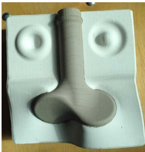
Рисунок 3.74 – Гипсовая форма с формованной заготовкой керамической мешалки
