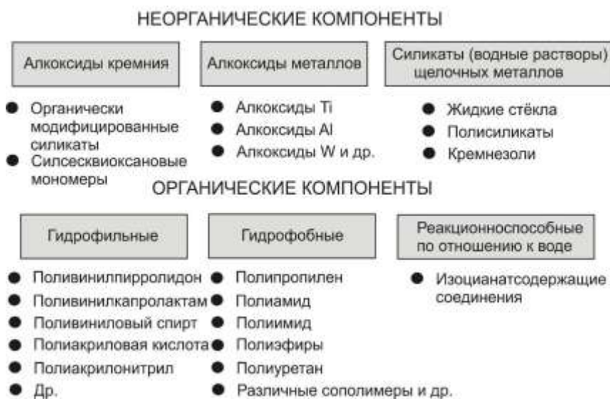
Рис. 1.6. Схема сочетания органических и неорганических компонентов в золь-гель методе получения гибридных материалов.
