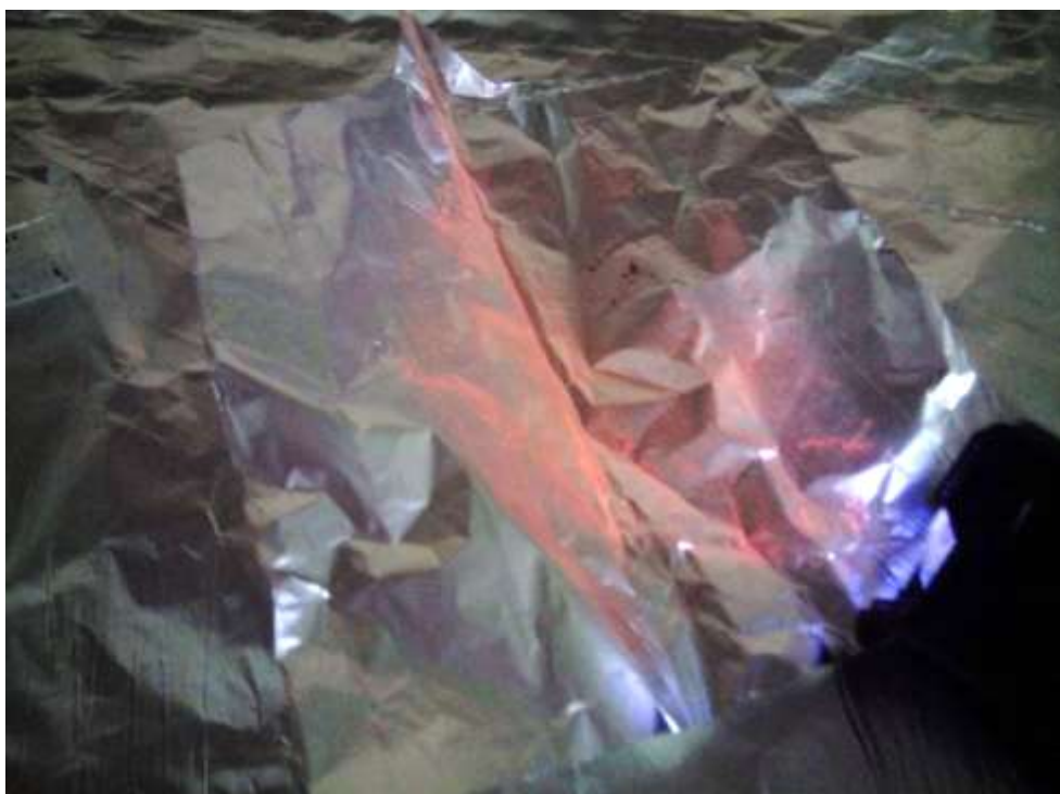
Рис. 4.6. Флюоресценция очищенного вакуумной сублимацией препарата Pt(2-Meq) 2 на алюминиевой фольге под воздействием УФ \lambda_{\text{ext}}=365\text{ нм} .
