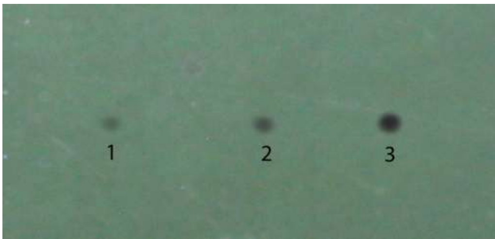
Рис. 5.7. Падение интенсивности люминесценции структуры с топологией ИТО/ ( \text{Alq}_3 10 нм/ \text{PbF}_2 10 нм) _n / Al 100 нм при лазерном воздействии на точку в течении: 1 – 1 секунды, 2 – 3 секунды, 3 – 5 секунд.
