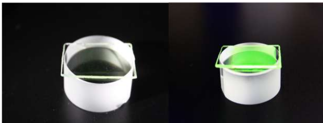
Рис. 5.8. Фотографии структуры типа III при естественном освещении (слева) и под УФ (справа).
