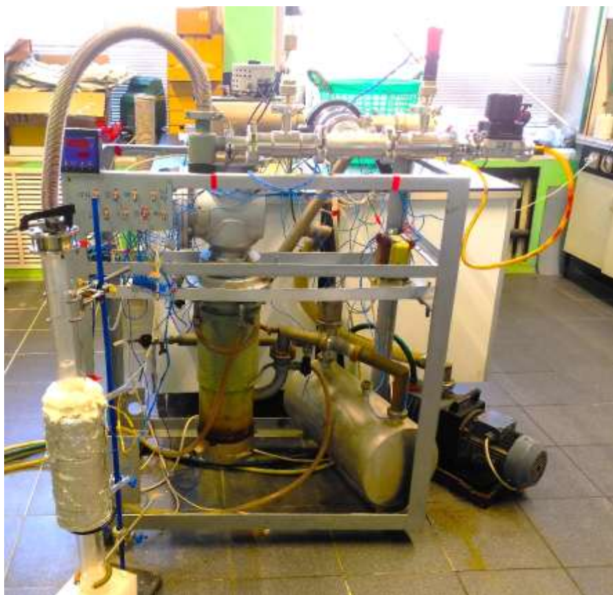
Рис. 3.3. Фотография установки для вакуумной сублимационной очистки с масляным диффузионным насосом.
