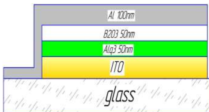
Рис. 5.2. Топология гетерофазной структуры на основе Alq 3 +В 2 О 3 .
