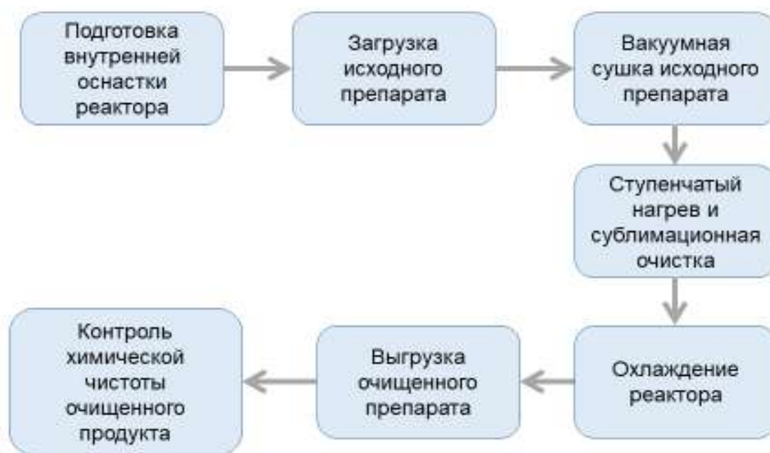
Рис. 3.2. Блок-схема с основными операциями при проведении вакуумной сублимационной очистки.
