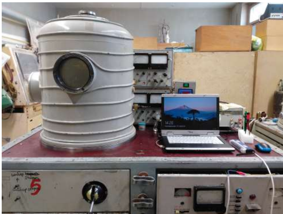
Рис. 2.7. Фотография внешнего вида установки вакуумного напыления УВН-71.
