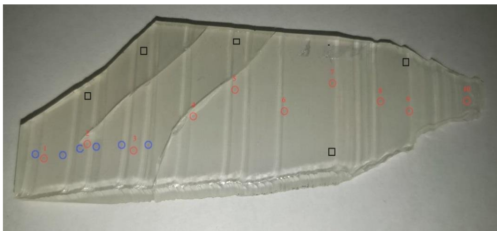
Рис. 102. Пластина LNM для исследования стехиометрии кристалла.
