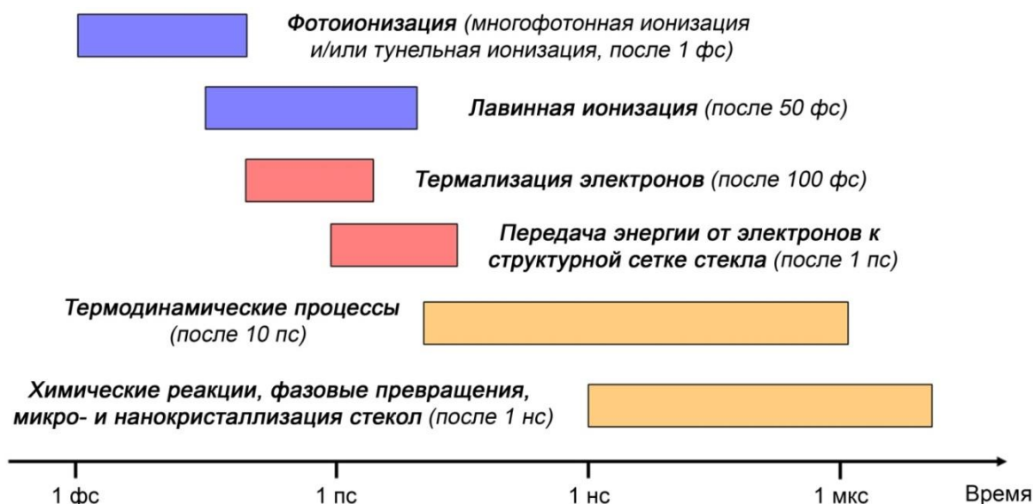
Рисунок 18 - Временная шкала процессов, происходящих при облучении стекол фемтосекундным лазерным излучением [100]
